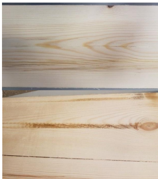
Рис. 4. Дефекты на поверхности шлифования в виде прижегов
