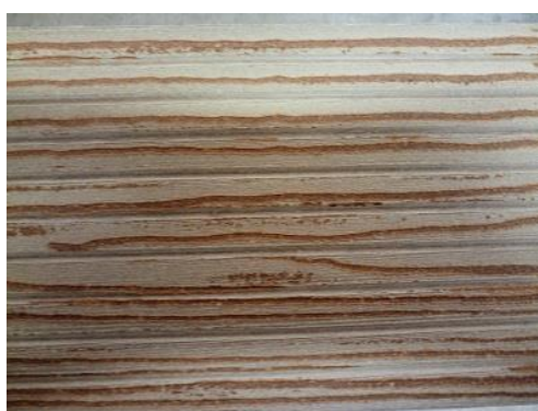
Рисунок 4.10 – Фотографии опытно промышленного образца декинга, полученного на технологической линии ООО «СкринЕК». 1 - вид образца с торца, 2 – цвет образца без шлифования и тиснения, 3 – образец после шлифования и тиснения.
