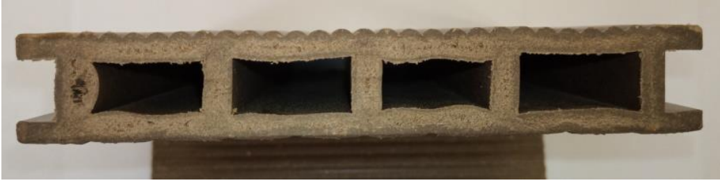
Рисунок 4.8 – Бракованная партия декинга, изогнутая поверхность, вздутия
