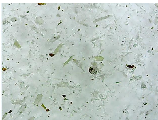
Рисунок 3.3 – Фотография древесной муки ДМ 180 с увеличением х60
