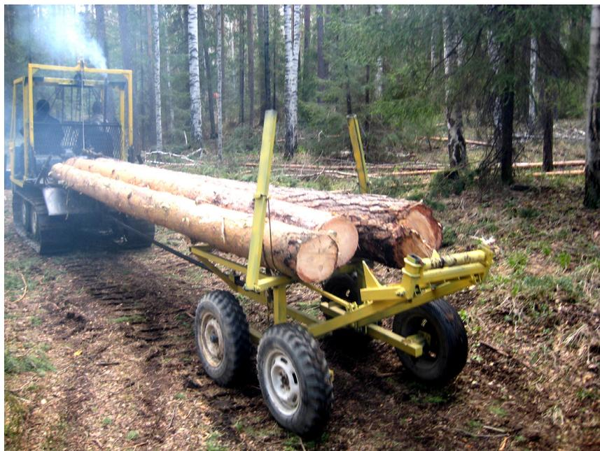
Рис. 3. Транспортировка 6-метровых сортиментов малогабаритным трактором ЛМТ-1
