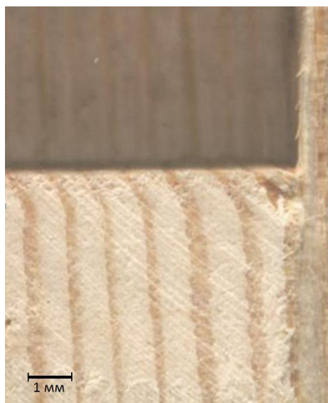
Рисунок 2.17 – Форма поверхности стенок и дна проушины (сосна, W = 8\% )
