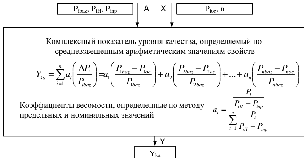
Рисунок 6.9 – Модель для расчета комплексного показателя уровня качества по средневзвешенным арифметическим значениям свойств
