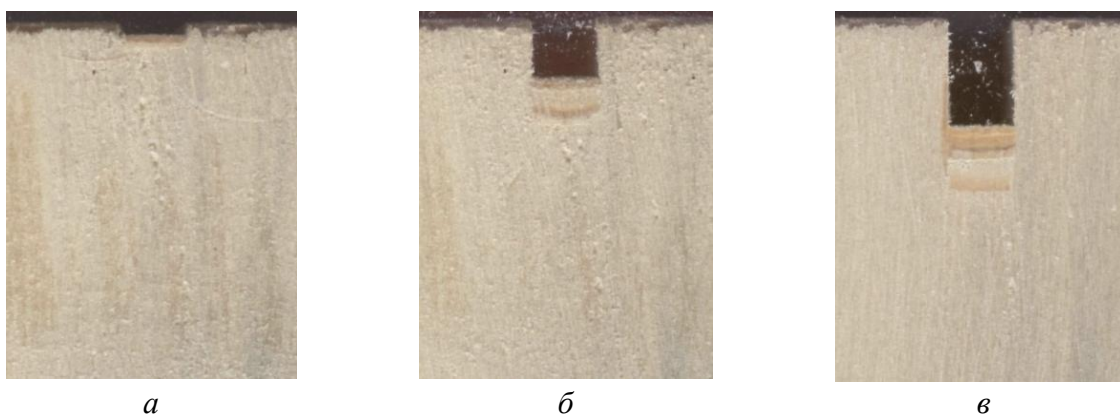
Рисунок 2.9 – Формирование проушины в древесине сосны, W = 8 \% , B = 4 мм, h_n = 7 мм: a - в – этапы процесса
