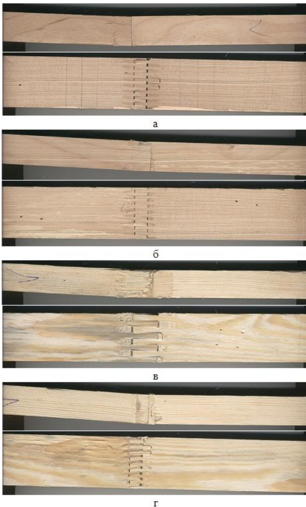
Рисунок 5.2 – Примеры разрушения образцов при испытаниях на изгиб: а-б – образцы из древесины березы; в-г – образцы из древесины сосны; а, б, г – типоразмер А; в – типоразмер Б
