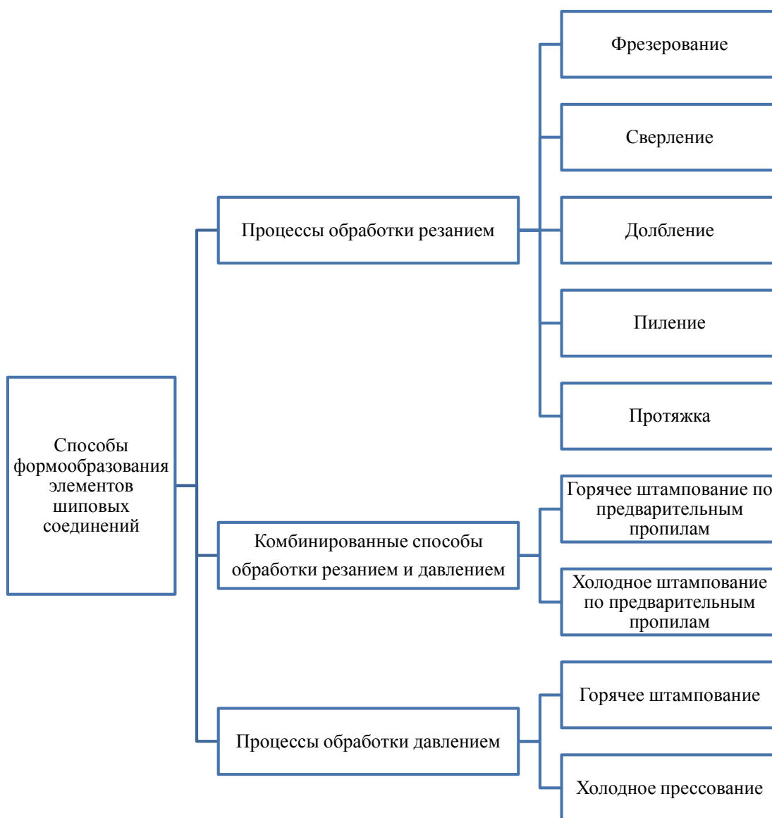
Рисунок 1.4 – Способы формообразования элементов шиповых соединений
