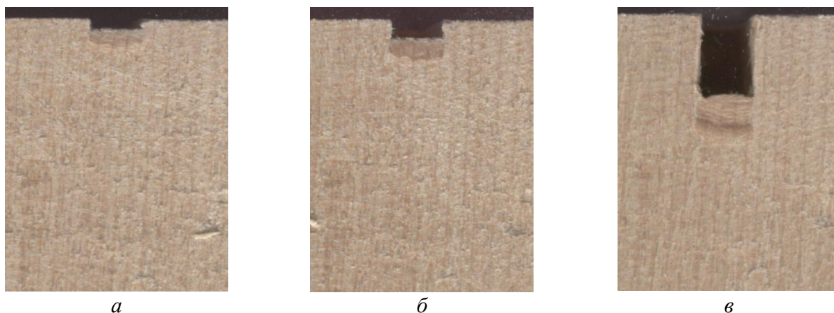
Рисунок 2.11 – Формирование проушины в древесине березы, W = 8 \% , B = 4 мм, h_n = 7 мм: a - в – этапы процесса
