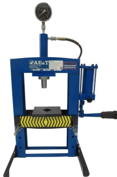
Рисунок 3.3 – Общий вид пресса Т61210М (АЕ&Т)
