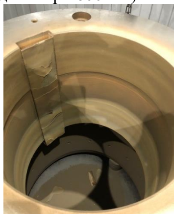
Рис. 2 Посадочная поверхность подпятника электродвигателя (вес 2894 кг)
