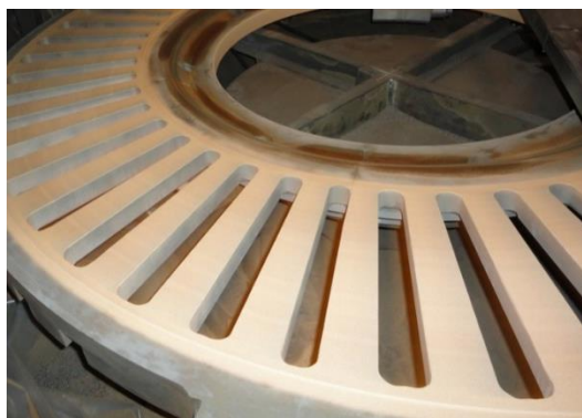
Рис. 1 Поворотное кольцо управляющей диафрагмы паровой турбины (вес 1 т., диаметр 2600 мм)
