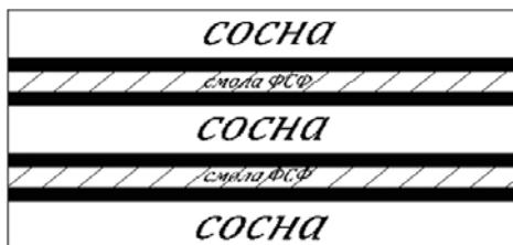
Рис. 2. Модель пакета фанеры из модифицированного шпона
