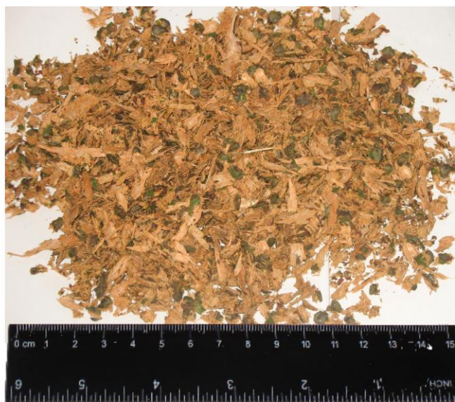
Рисунок 4.12 - Элементы коры пихты после окорки с промышленными скоростями подачи
