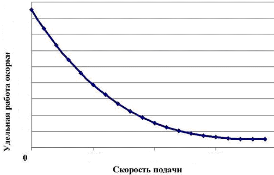
Рисунок 2.7 – Зависимость удельной работы окорки от скорости подачи
