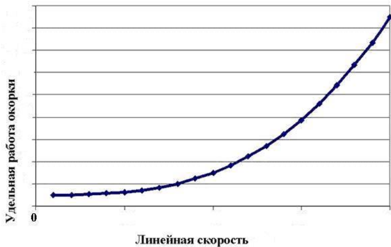
Рисунок 2.6 – Зависимость удельной работы окорки от линейной скорости цепи
