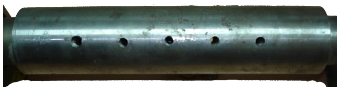
Рисунок 3.3 - Общий вид приводного вала с четырьмя прямыми рядами отверстий для крепления кронштейнов с ЦРО
