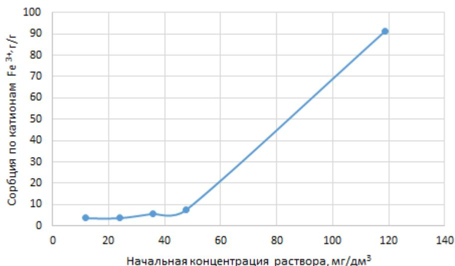
Рисунок 3.8 – Зависимость сорбции Fe<sup>3+</sup> БАУ от начальной концентрации ионов
