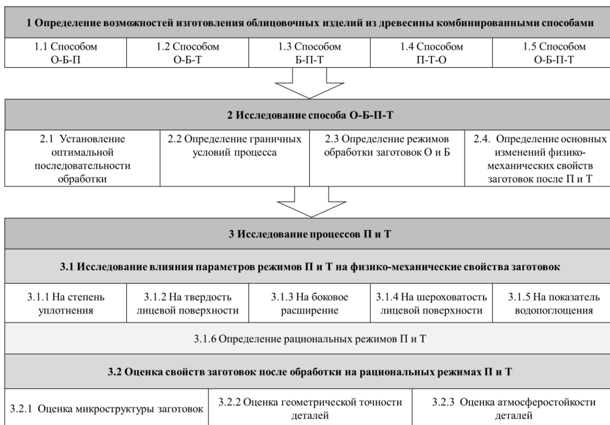
Рисунок 2 – Программа проведения экспериментальных исследований: О – обжиг; Б – браширование; П – прессование; Т – термическая обработка
