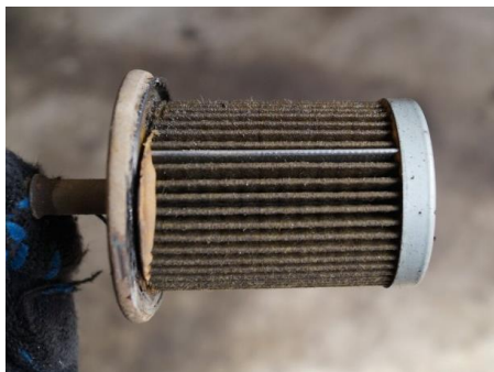
Рис. 1. Пример засоренного топливного фильтра
