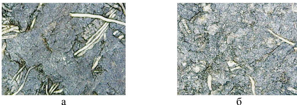
Рис. 3. Микрофотография (x40) образцов ПБС после экспозиции в грунте: а – кокосовый субстрат; б – измельченный кокосовый субстрат
