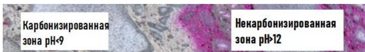
Рис. 2. Качественный анализ бетона на карбонизацию (индикатор–фенолфталеин)
