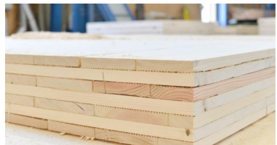
Рис. 8. Элемент дома, собранный по технологии machined house
