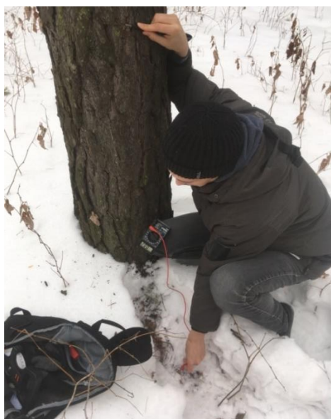
Измерение напряжения древостоя сосны: a – в зимний период, б – в летний период времени года
