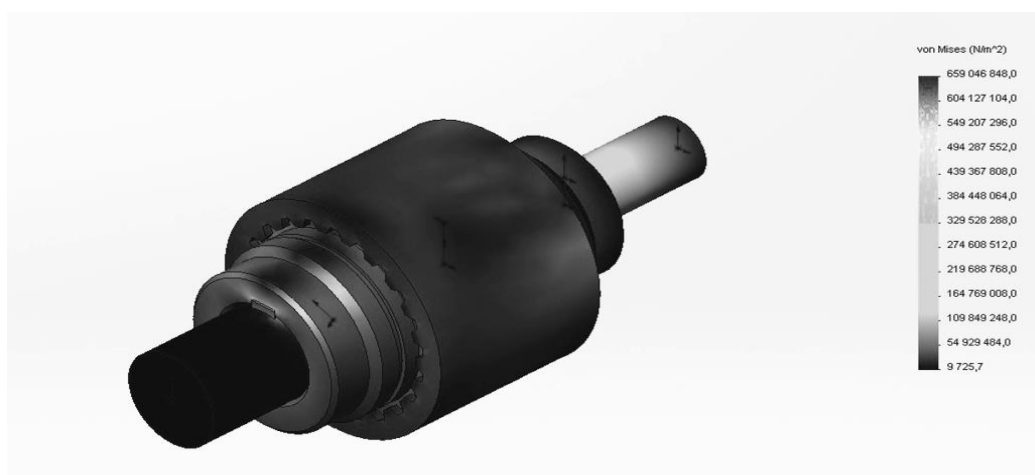
Рис. 4. Поля распределения напряжений в материале муфты
