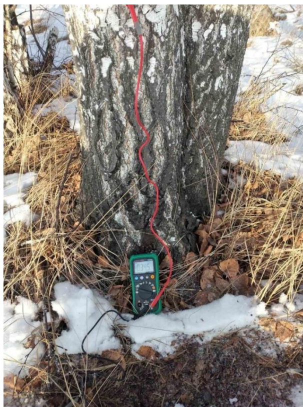
Измерение напряжения в березе в зимний период
