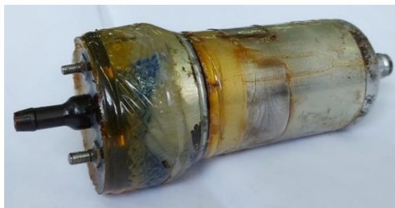
Рис. 2. Топливный насос после герметизации эпоксидной смолой
