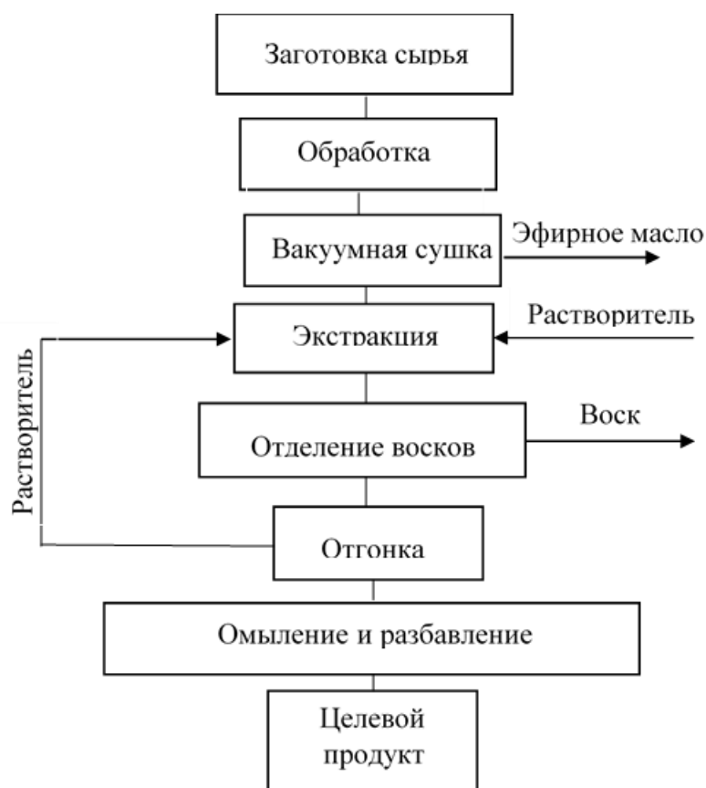
Технологическая схема переработки хвойной зелени
