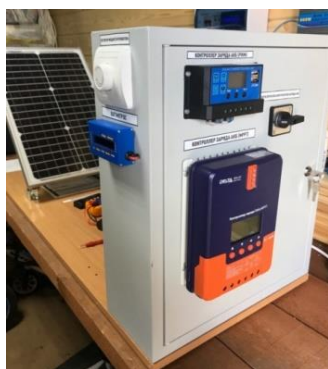
Рис. 1. Внешний вид лабораторного стенда «Исследование характеристик ФСМ»
