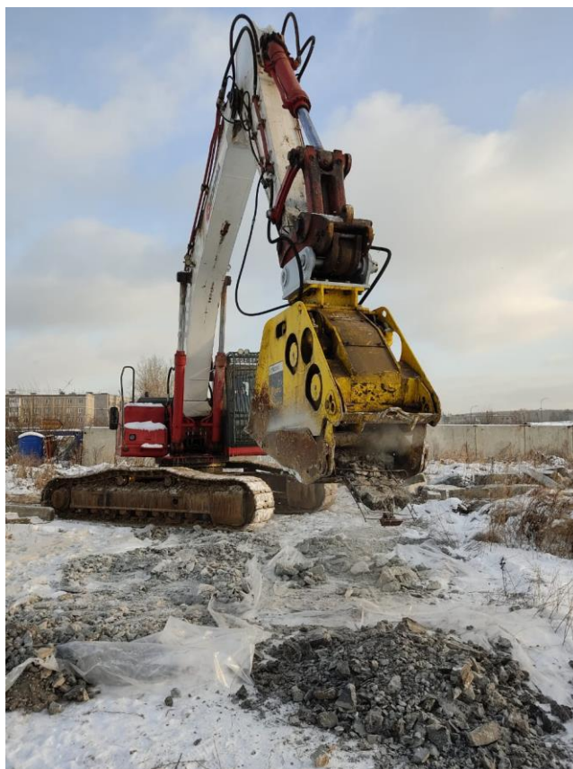
Получение вторичного щебня с помощью дробильного ковша
