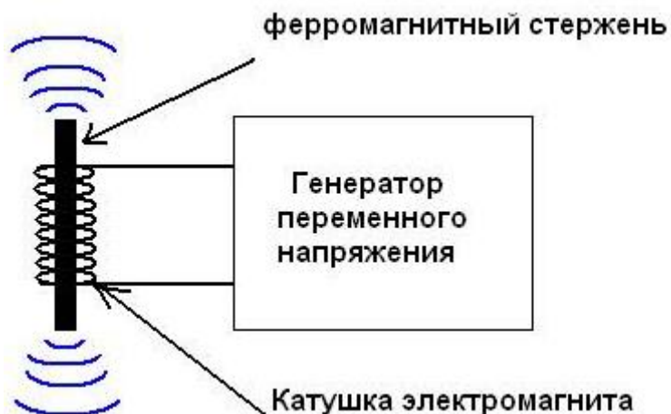
Рис. 3. Структурная схема ультразвукового излучателя
