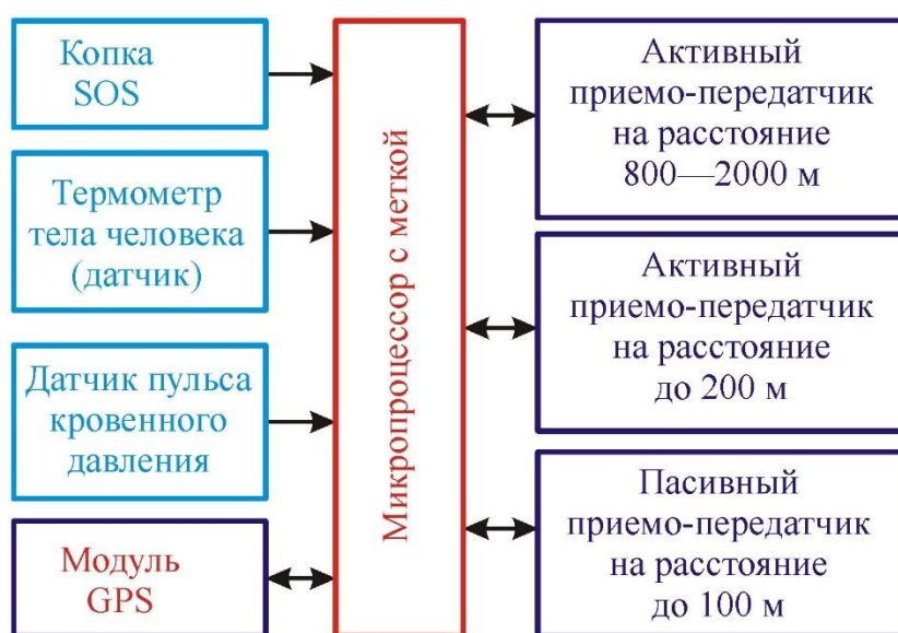
Рис. 1. Поисково-туристический радиодатчик (структурная схема)
