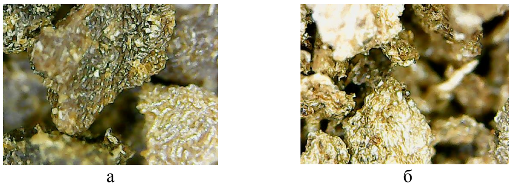
Рис. 1. Микрофотография (x40) исходного пресс-сырья: а – скорлупа кокосового ореха; б – измельченный кокосовый субстрат
