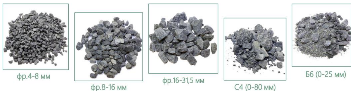
Рис. 5. Щебень из плотных горных пород по ГОСТ 8267–93 с Баженовского месторождения
