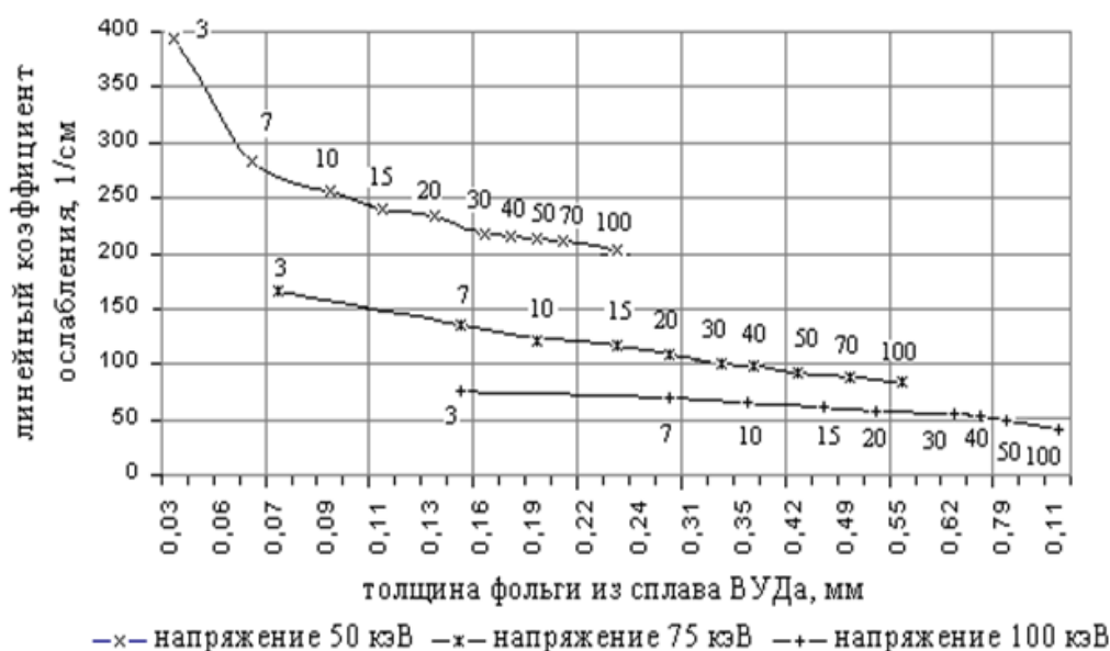
Рисунок 2.16 – Зависимость линейного коэффициента ослабления фольги из сплава Вуда от ее толщины (цифрами обозначена кратность ослабления рентгеновских лучей)
