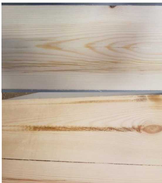
Рис. 4. Дефекты на поверхности шлифования в виде прижегов
