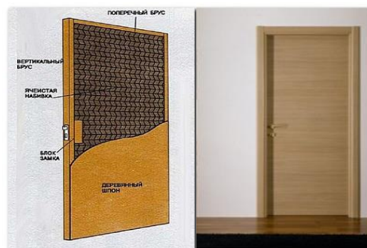
Рис. 1. Конструкция щитового дверного блока
