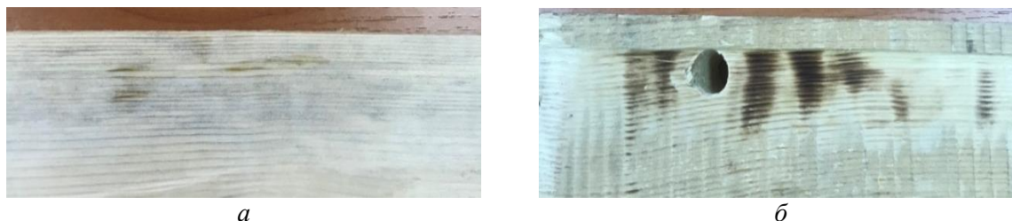
Рис. 5. Поверхность древесины осины с прижогом после обработки шлифовальным кругом на основе: a – ППУ (Россия); б – ESSEGI (Италия)
