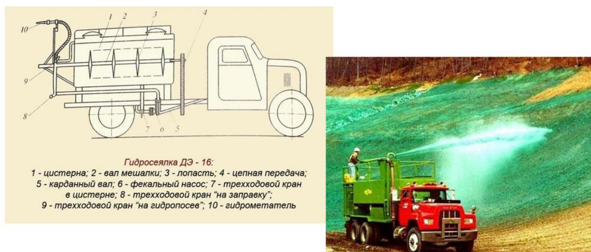
Рис. 1. Способ гидропосева
