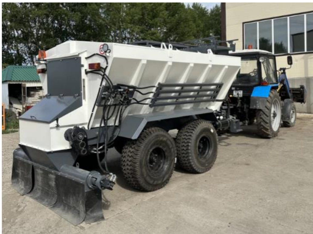
Рис. 2. Цементораспределитель МВЦ 8АГ от ООО «УралАгроМаш»
