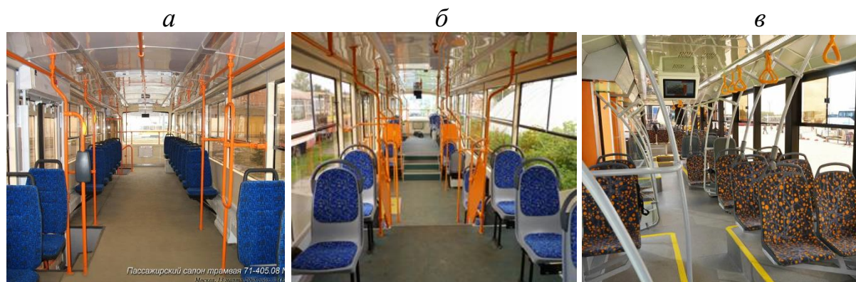
Виды компоновки вагонов трамвая в зависимости от уровня его пола: а – вагоны с высоким уровнем пола; б – вагоны с переменным уровнем пола; в – вагоны с низким уровнем пола
