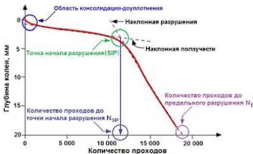
Рисунок 3.10 – Кривая пластического колееобразования [59]
