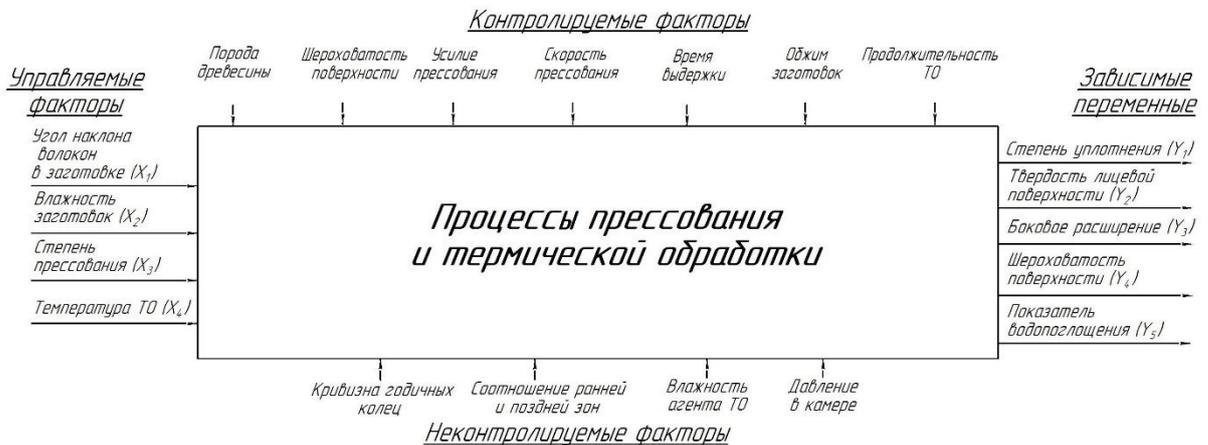
Рисунок 4.8 – Схема описания процессов на этапе упрочнения заготовок из древесины сосны
