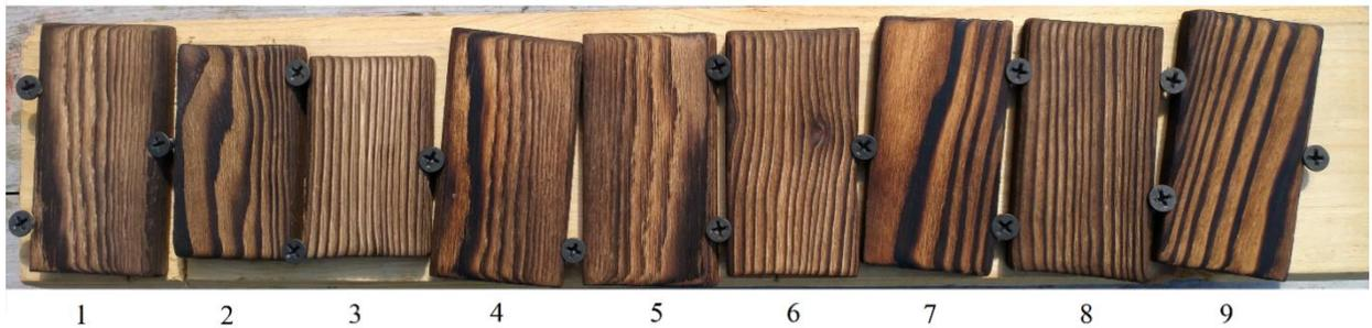
Рисунок 3.7 – Образцы для испытаний заготовок на атмосферостойкость
