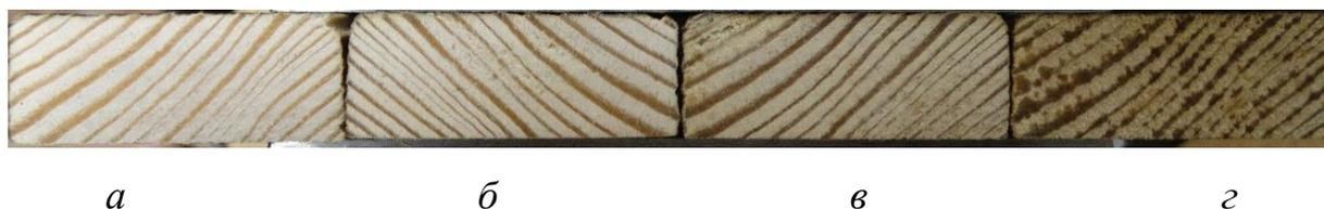
Рисунок 4.5 – Изменение цвета древесины при термической обработке:
