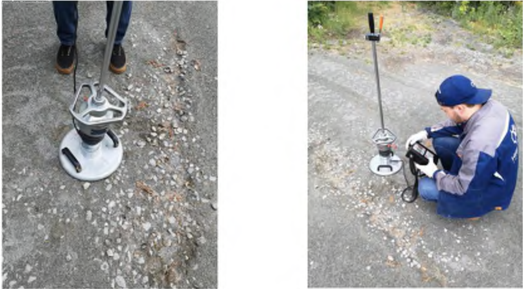
Рисунок 3.11 – Обследование дорожных конструкций из некондиционных материалов динамическим прогибомером ZFG (координаты опытного участка 59.757660, 59.979640)
