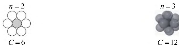
Рисунок 2.1 – Число контактов между частицами для идеальной дискретной среды в двумерном ( n=2 ) и трехмерном пространстве ( n=3 ) (по материалам W. F. Murphy )
