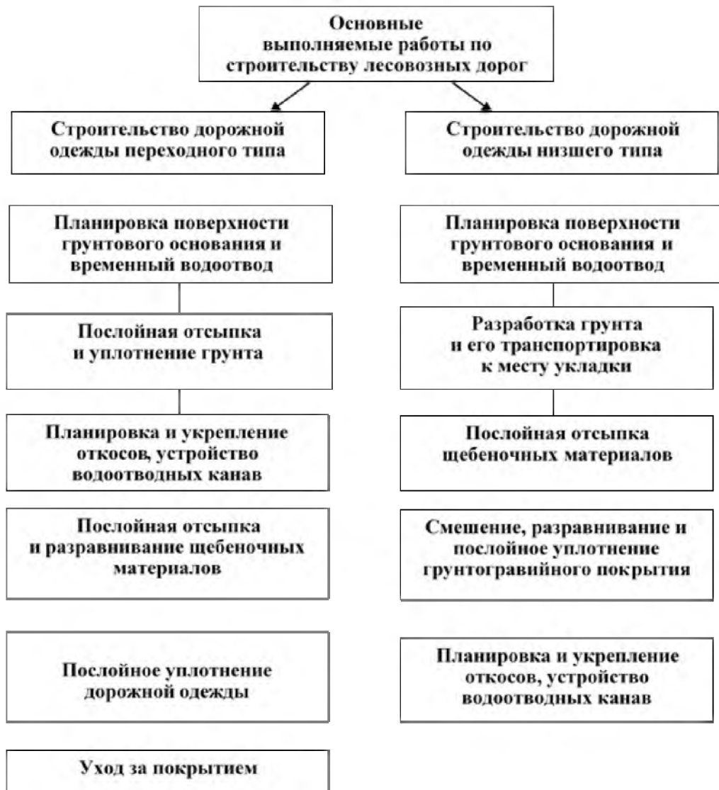
Рисунок 4.10 – Последовательность работ при строительстве лесовозных дорог
