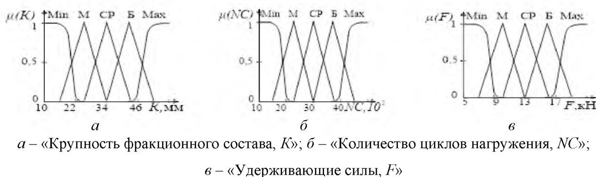
Рисунок 2.8 – Нечеткие функции принадлежности
