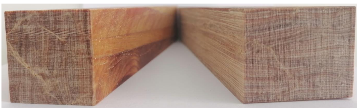
Рис. 2. Образец PSL № 2 на эпоксидном связующем с карданолсодержащим основанием Манниха после механической обработки
