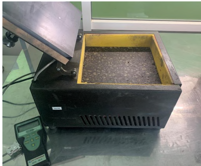
Рисунок Г.3 – Измерение теплопроводности асфальтобетонного покрытия
