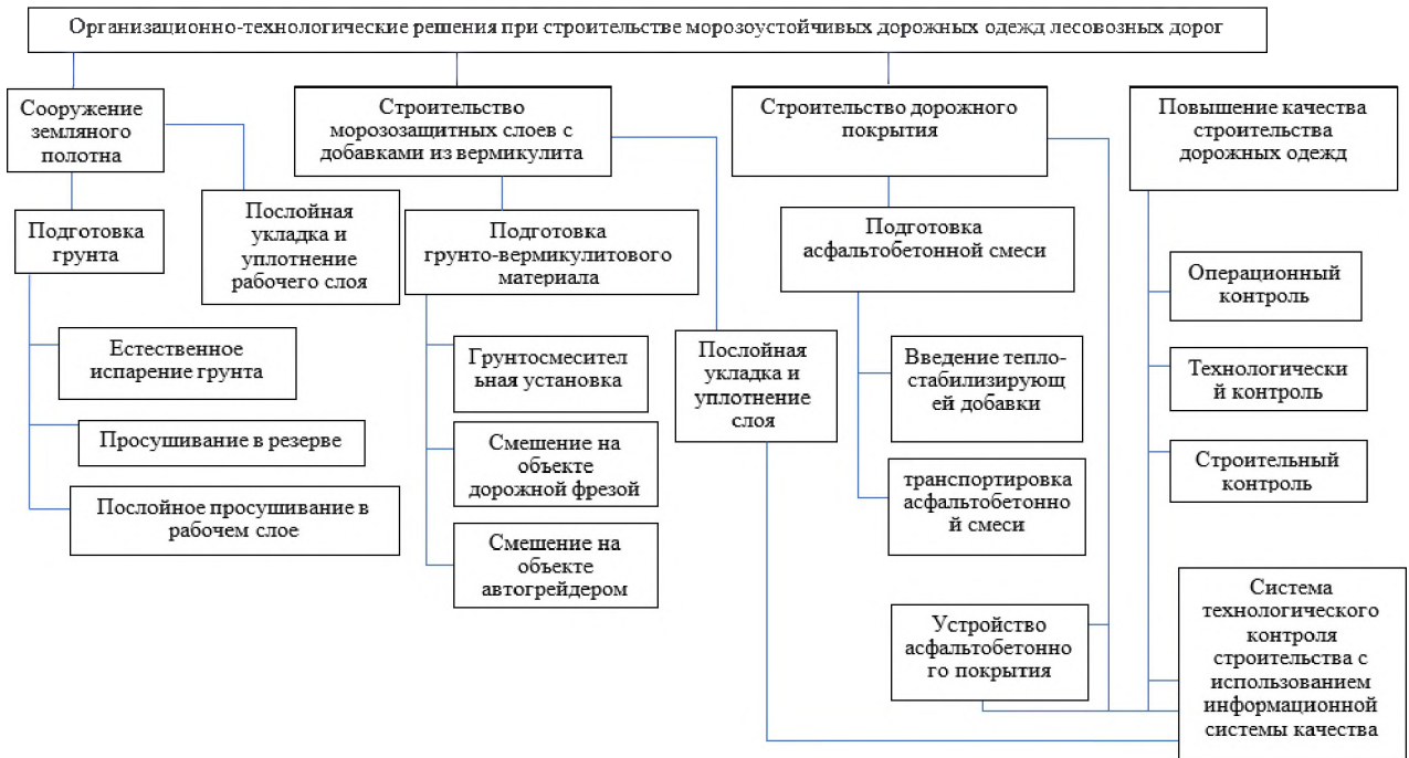
Рисунок 4.1 – Организационно-технологические решения при строительстве морозоустойчивых дорожных одежд лесовозных дорог
