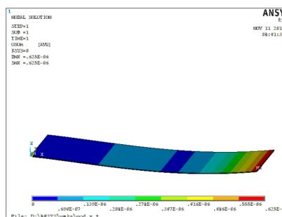
Рис. 7. Деформация пластины 3D  $\Delta = 0,625 \cdot 10^{-6}$  м
