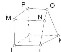
Рис. 4. Конечный элемент solid 185
