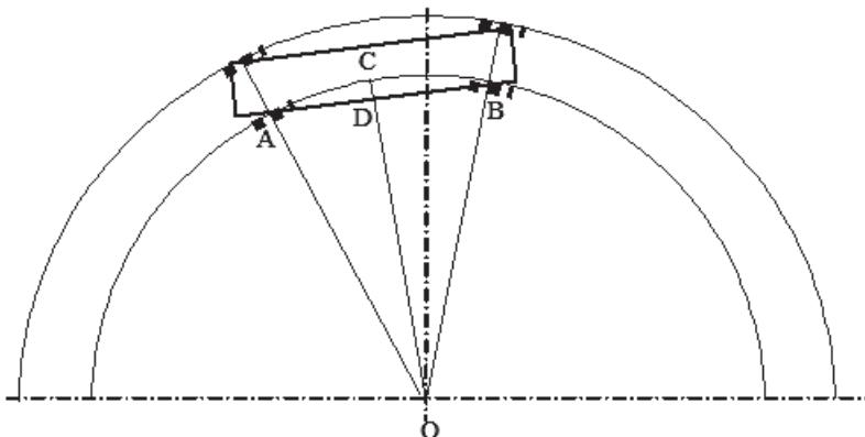
Рис. 3. Схема расчета ширины прохода для ЛТМ с двумя парами колес при движении по одной кривой
