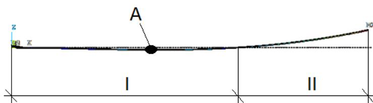
Рис. 11. Форма деформации пластины при гравитации в преднапряженном расчете
