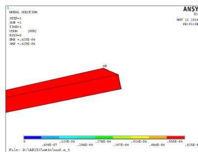
Рис. 8. Деформация верхнего слоя (вид 2D)
