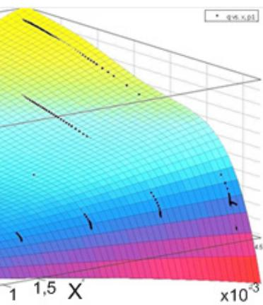
Рис. 2. Зависимость величины потока рабочей жидкости через гидрораспределитель от разницы давления  $P$  в полостях ГЦ и положения штока гидрораспределителя  $X$
