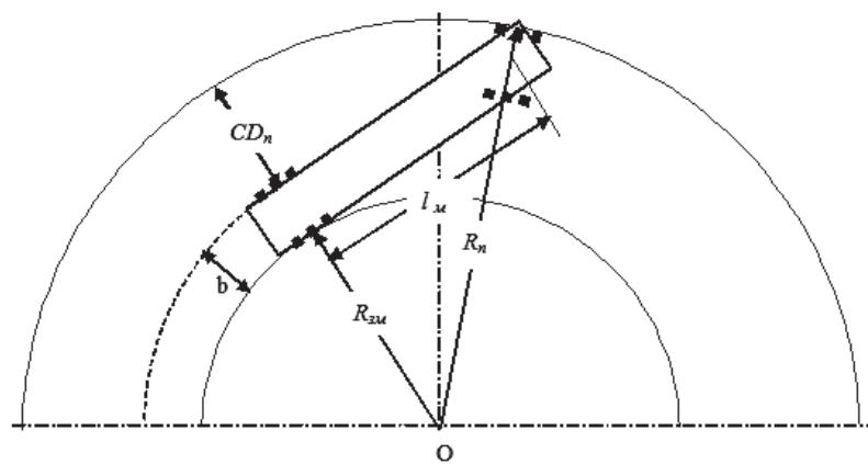
Рис. 1. Схема расчета ширины прохода для ЛТМ с одной парой управляемых колес при движении по кривой
