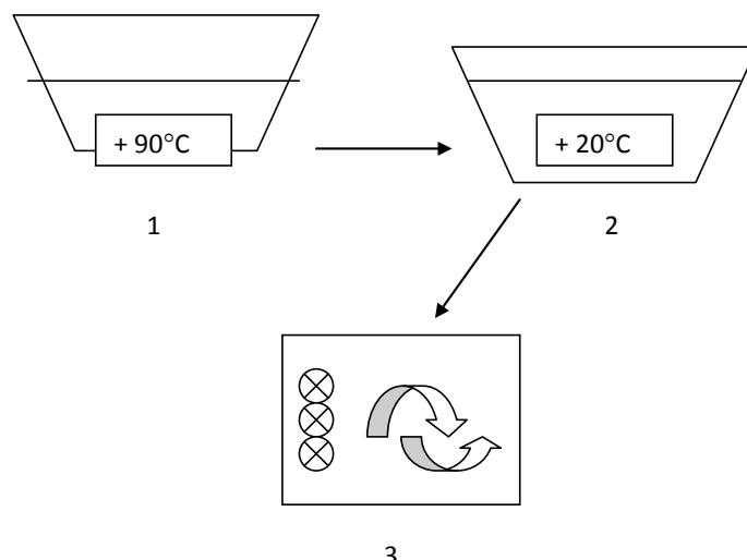
Рис. 1. Технологическая схема пропитки методом «разница температур»:
