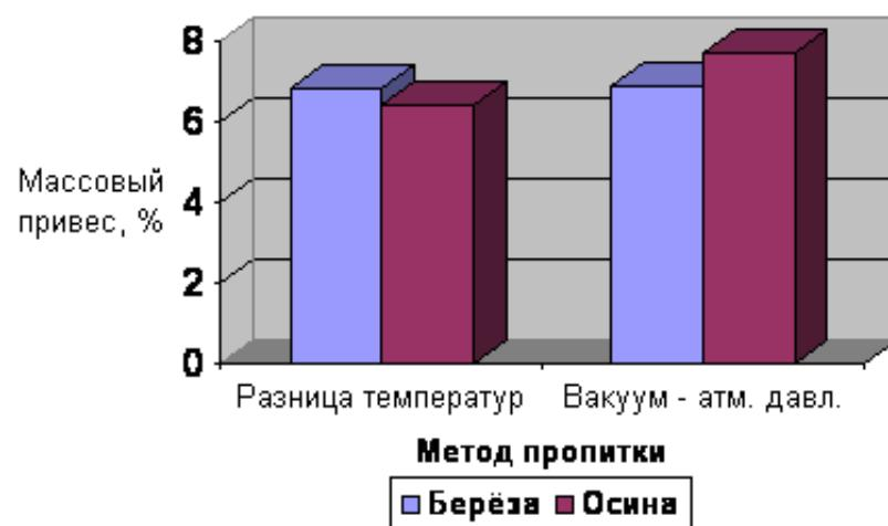
Рис. 3. Массовый привес полимера в древесине березы и осины
