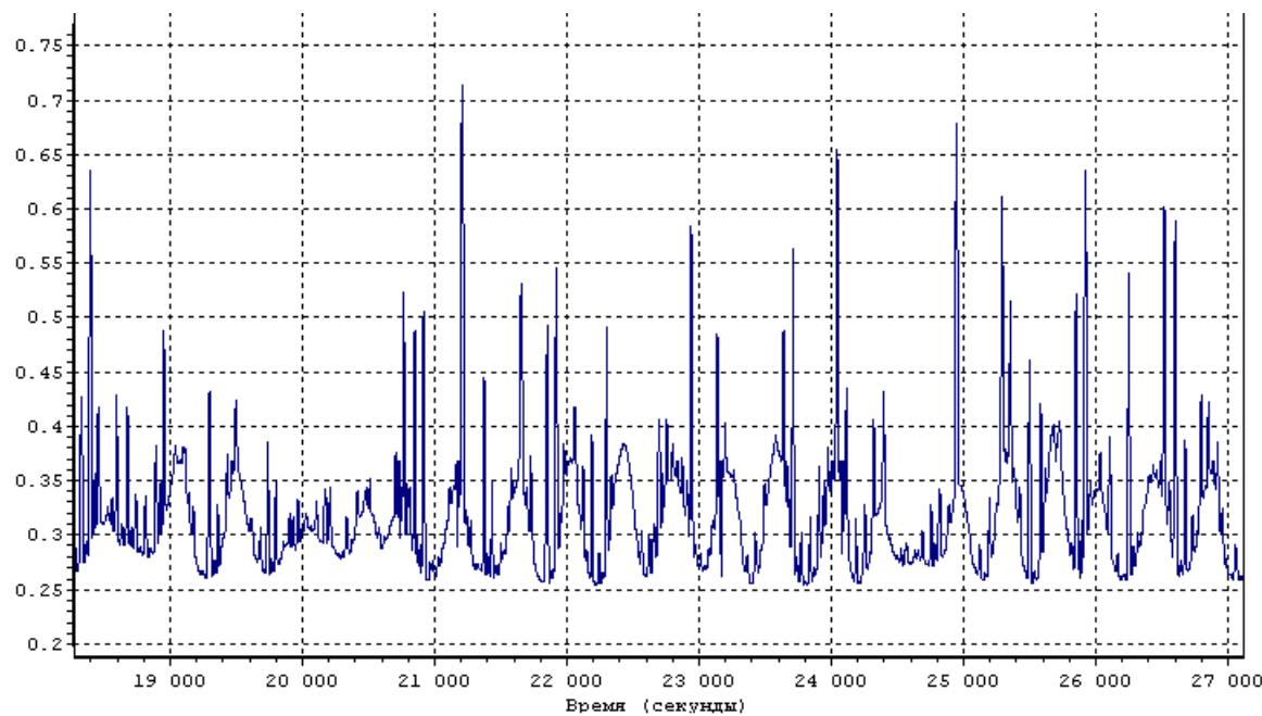
Рис. 3. Процесс динамических нагрузок на короснимателе, полученный на основе решения задачи нечеткого вывода
