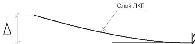
Рис. 2. Деформации пластины с ЛКП  $\Delta = 0,000625$  мм
