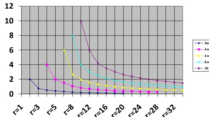
Рис. 2. Зависимость уширения коридора, необходимого для прохода ЛТМ с передними управляемыми колесами, в зависимости от радиуса поворота при различных длинах ЛТМ
