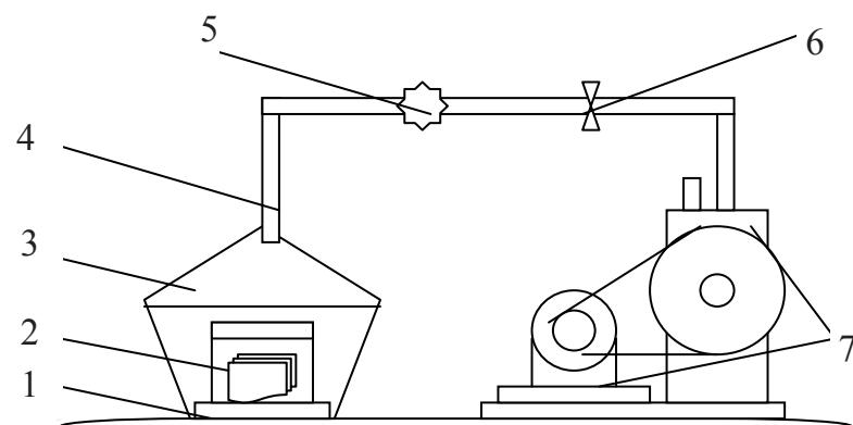
Рис. 2. Схема прибора для пропитки образцов методом «вакуум – атмосферное давление»:
