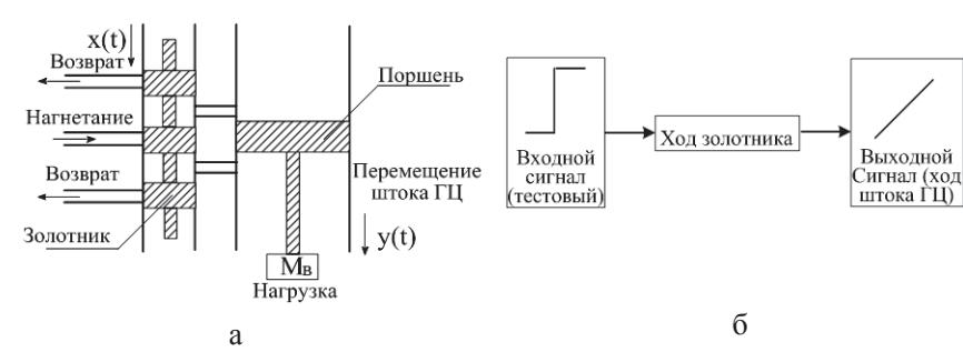
Рис. 1. Схема работы гидравлической системы:
