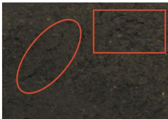
Рис. 1. Сканография образцов ПБС на основе гидролизованного лигнина: ○ – микротрещина, □ – изломанность
