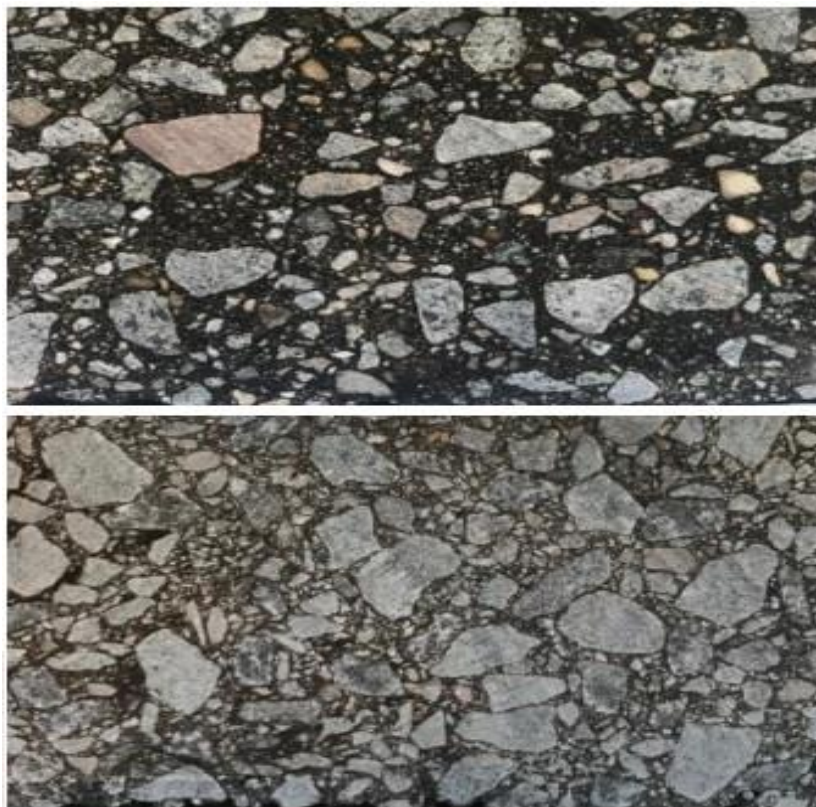
Рис. 1. Фото образцов асфальтобетонов с разным составом минеральной составляющей
