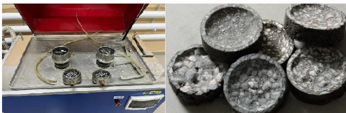
Рис. 5. Установка для проведения испытания на «истирание» асфальтобетона. Внешний вид образцов после испытания
