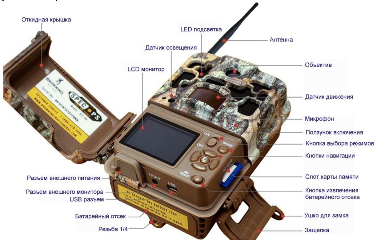
Рис. 2. Пример устройства фотоловушки
