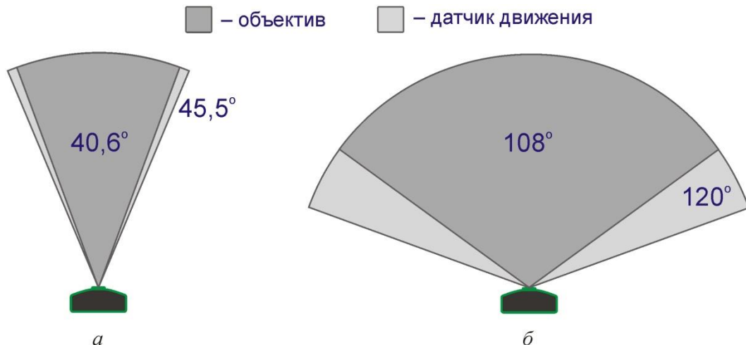
Рис. 3. Примеры обзора объектива и захвата датчика движения фотоловушек: a – с узким углом обзора; б – с широким углом обзора
