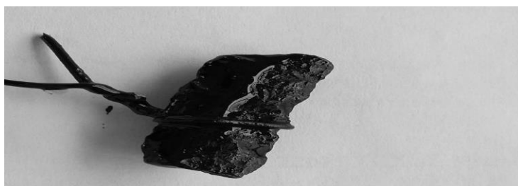
Рис. 1. Гранитный щебень с добавкой «НИТОН марка Д1» после испытаний
