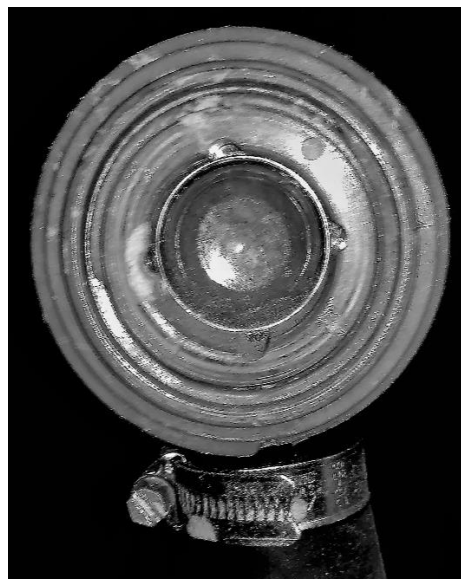
Рис. 2. На заглушке вихревого очистителя с повышенной вибрацией следа от вакуумного столба нет
