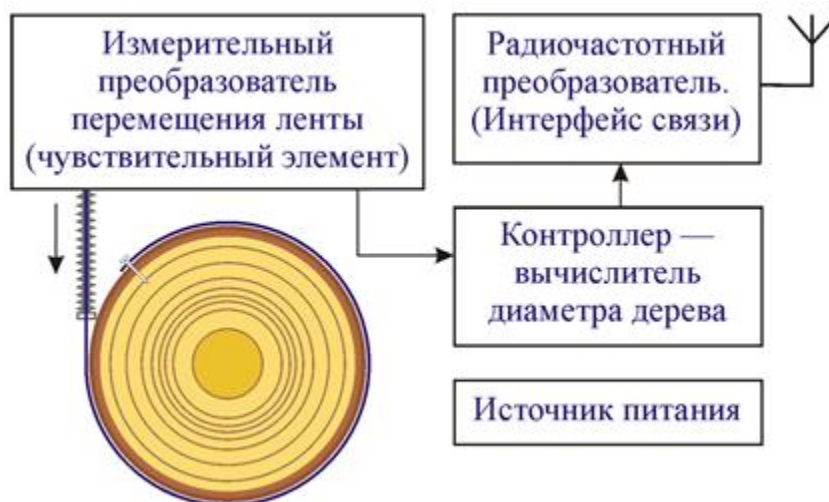
Рис. 2. Структурная схема измерителя диаметра дерева по обхвату
