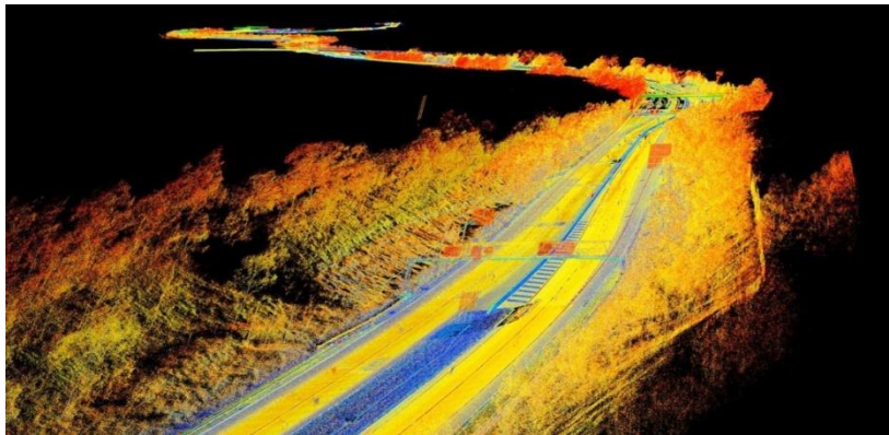
Рис. 2. Пример результата съемки автомобильной дороги лазерным сканером
