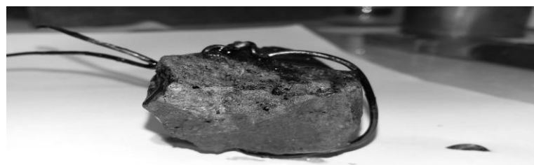
Рис. 4. Известняковый щебень, покрытый битумом без добавки
