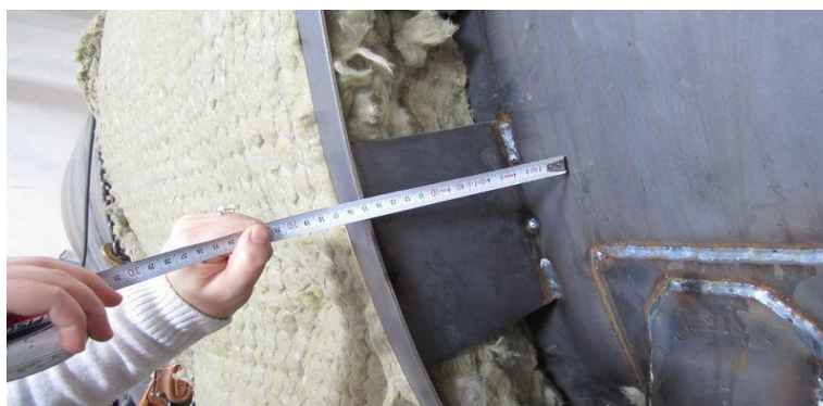
Рис. 2. Двойные стенки битумовоза
