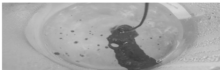
Рис. 3. Гранитный щебень, покрытый битумом без добавки
