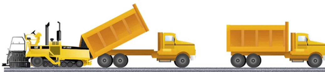
Рис. 1. Технологическая схема укладки асфальтобетонной смеси по традиционной технологии
