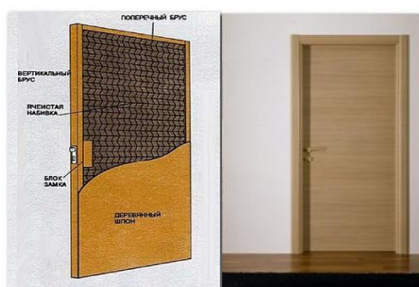
Рис. 1. Конструкция щитового дверного блока
