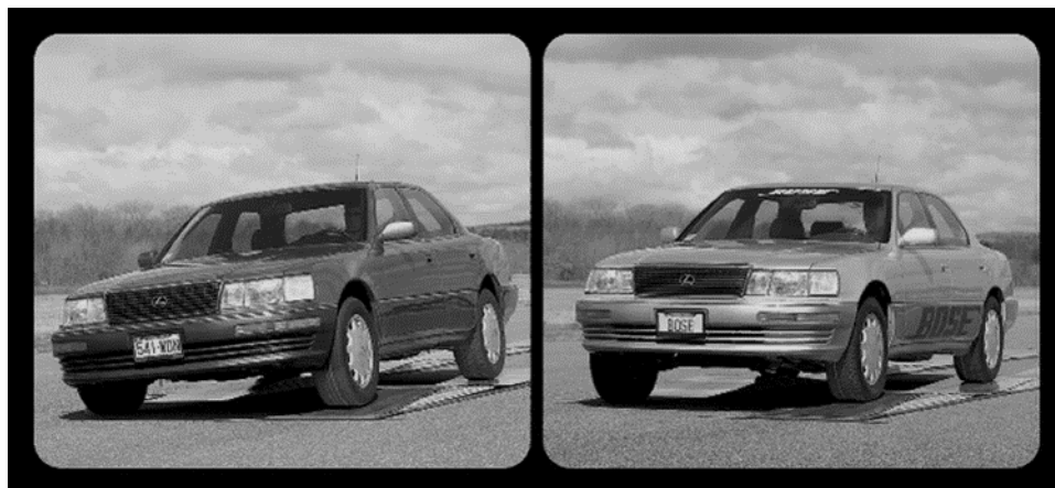
Рис. 2. Работа пружинной и электромагнитной подвески на неровности
