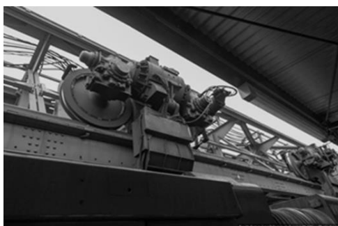
Рис. 3. Монорельсовая подвесная дорога системы Ойгена Лангена. Подвесная конструкция
