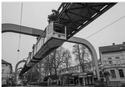
Рис. 1. Монорельсовая подвесная дорога системы Ойгена Лангена над проезжей частью
