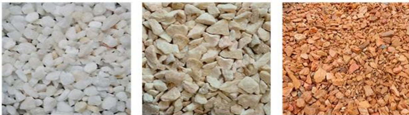
Рис. 2. Пример каменных материалов ярких цветов, используемых для приготовления цветных асфальтобетонных смесей
