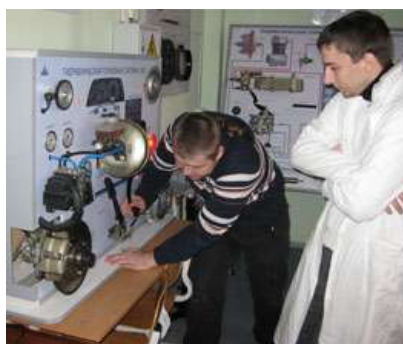
Гидравлическая тормозная система с АБС
