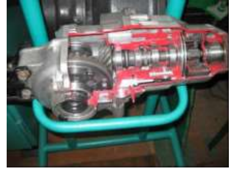
Механизм привода задних колес Honda CR-V
