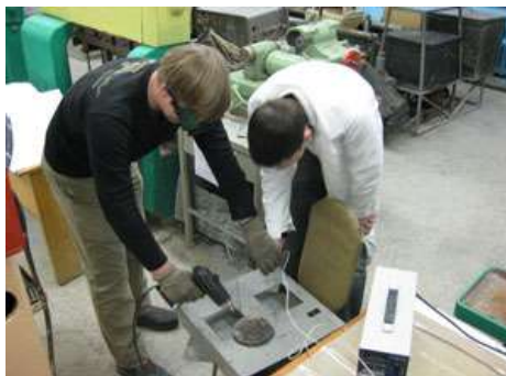
Плазменный аппарат "Мультиплаз 2500М"
