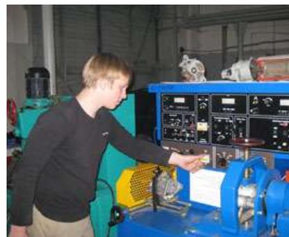
Стенд для балансировки колес СБМП-40
