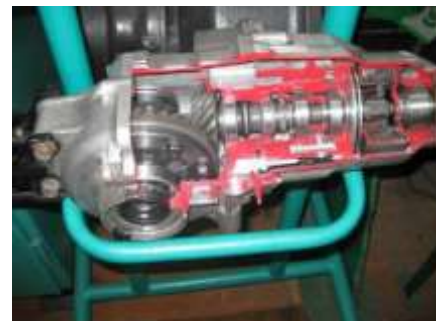
Механизм привода задних колес Honda CR-V
