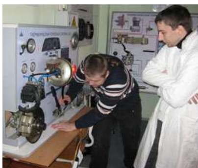
Электронный стенд для регулировки и диагностики дизельной аппаратуры ЕДС8
