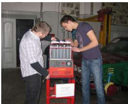
Электронный стенд для регулировки и диагностики дизельной аппаратуры ЕДС8
