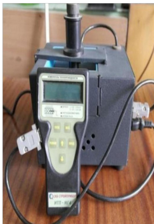
Рис. 2. Внешний вид прибора для измерения коэффициента теплопроводности
