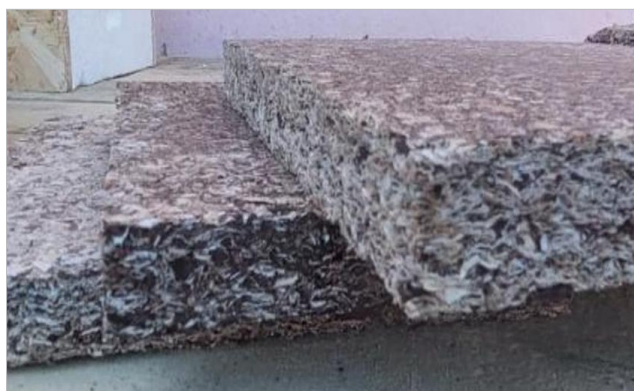
Рис. 1. Лабораторные образцы древесно-торфяных композитов
