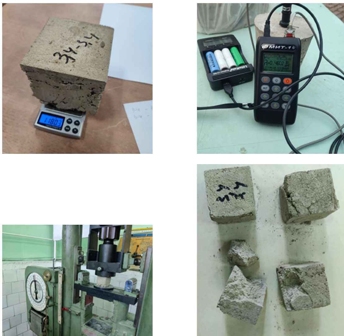
Рис. 6. Измерение массы, теплопроводности и прочности образцов Fig. 6. Measurement of mass, thermal conductivity and strength of samples
