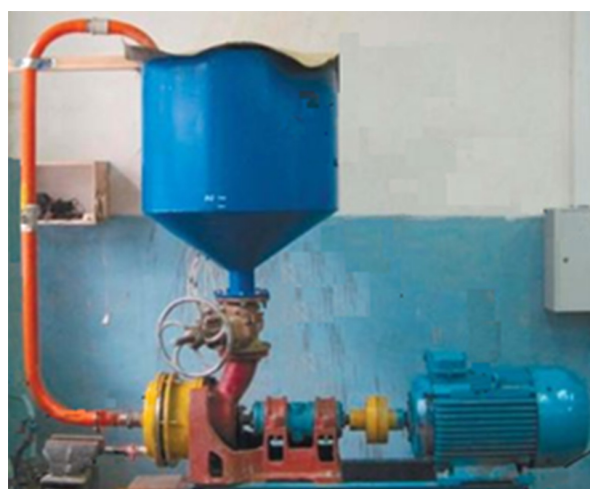
Рис. 2. Общий вид экспериментальной установки РГГД-1: 1 – бак; 2 – электродвигатель; 3 – гидродинамический диспергатор; 4 – запорная арматура (задвижка); 5 – труба циркуляционная Fig. 2. General view of the experimental setup RGGD-1: 1 – tank; 2 – electric motor; 3 – hydrodynamic disperser; 4 – shut-off valve (gate valve); 5 – circulation pipe
