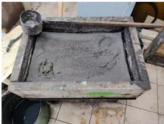
Рис. 4. Кавитированная древесная масса Fig. 4. Cavitated wood pulp
