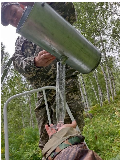
Рисунок 4.13 – Перемещение жидких осадков из осадкомера в мерную колбу для первичного определения их количества
