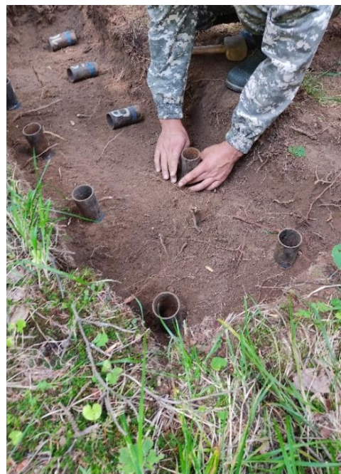
Рисунок 5.4 – Установка металлических трубок и их закрепление
