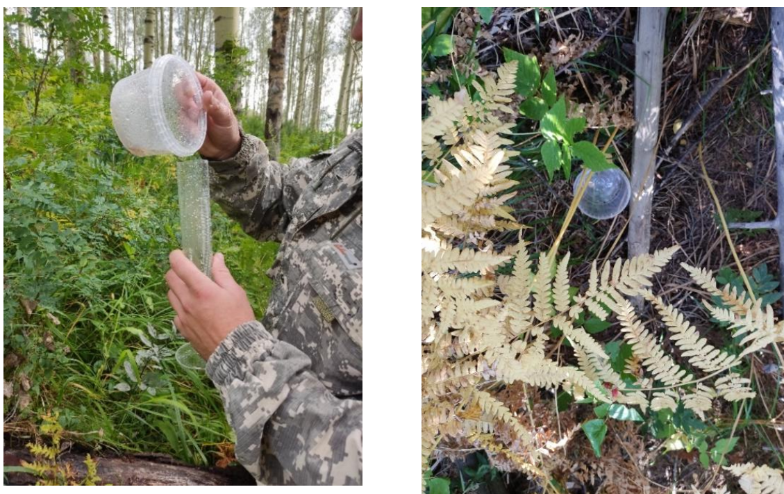
Рисунок 4.14 – Мерные емкости, установленные под травяным покровом
