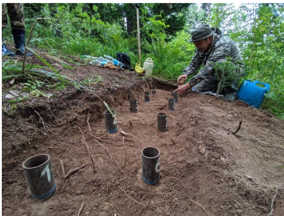
Рисунок 5.5 – Определение водопроницаемости почвы методом трубок в почвенном горизонте 0–10 см (ППИ№ 3)
