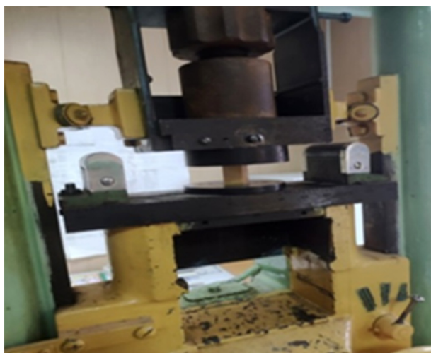
Рис. 6. Проведение испытаний по определению предела прочности при сжатии вдоль волокон
