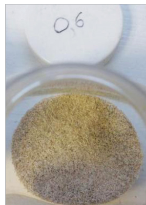
Рис. 4. Сита: слева – для разделения древесной муки на фракционный состав, справа – полученные фракции древесной муки 0,6 и 0,25 мкм Fig. 4. Sieves: on the left – for separating wood flour into fractional composition, on the right – the obtained fractions of wood flour 0,6 and 0,25 microns
