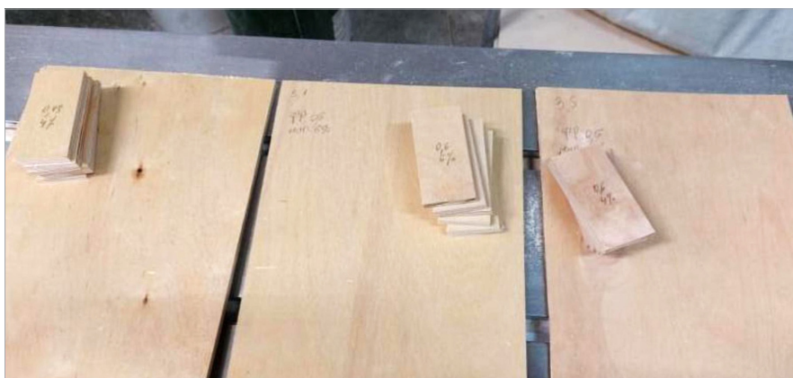
Рис. 6. Склеенная фанера и образцы для определения предела прочности фанеры при скалывании
