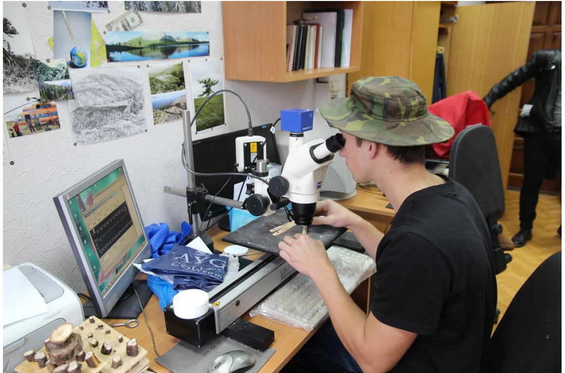
Рисунок 3.6 – Подсчёт годичных колец на полуавтоматической установке Lintab – 5
