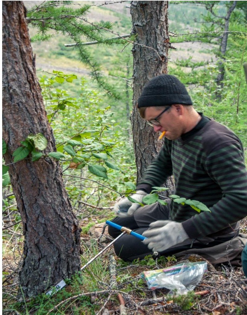
Рисунок 3.4. – Отбор образцов (керна) древесины возрастным буравом
