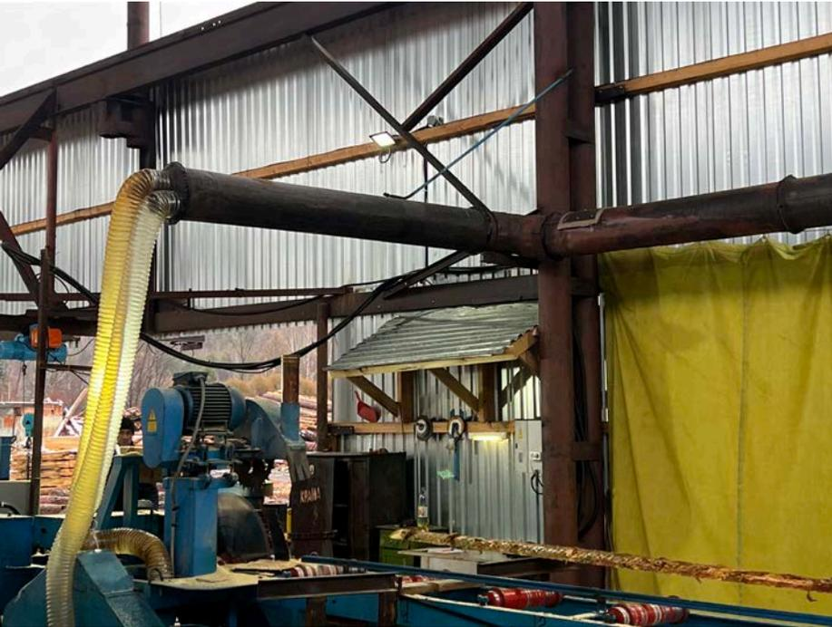
Установлен пневмотранспорт и аспирационная система.
