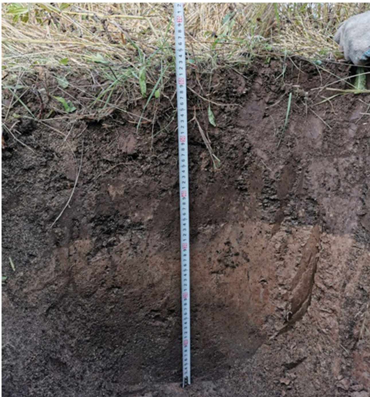
Рис. 3. Разрез 11Р, глубина 64 см, окультуренная дерново-подзолистая почва Fig. 3. Section 11P, depth 64 cm, cultivated sod-podzolic soil
