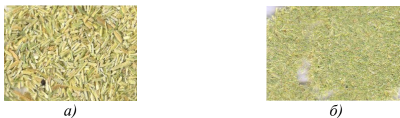
Рис. 2. Сканография исходного пресс-сырья в виде фракционированной биомассы тростника: а) – фракция 1,2 мм и менее; б) – фракция 0,7 мм и менее
