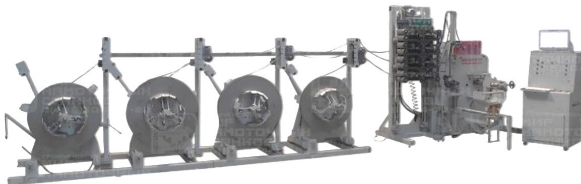
Рис. 3. Намоточный станок с четырьмя размотчиками
