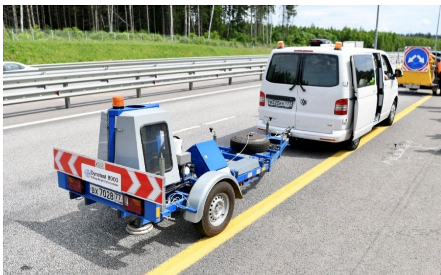
Рис. 1. Установка динамического нагружения падающим грузом
