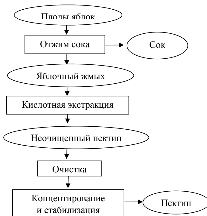
Блок-схема получения яблочного пектина
