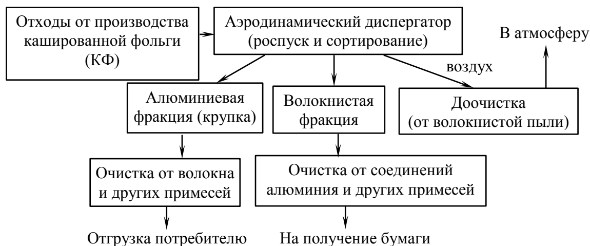
Рис. 2. Схема переработки отходов кашированной фольги сухим способом с использованием аэродинамического диспергатора
