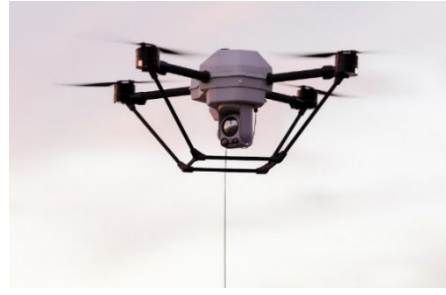
Рис. 9. Полезная нагрузка для БПЛА (видеокамера)
