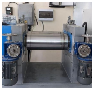
Рис. 19. Вальцы лабораторные марки ПД-320-160/160
