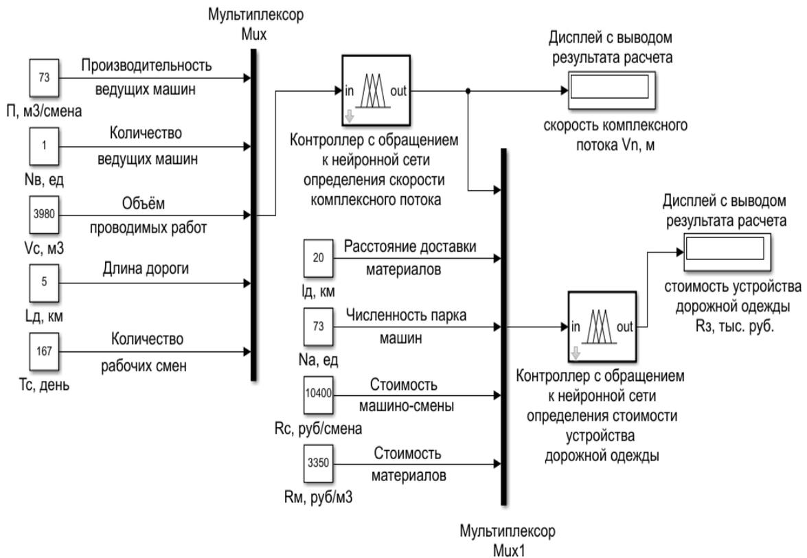
Рисунок 7 – Реализация интеллектуальной системы в среде визуально-блочного моделирования *Simulink*
