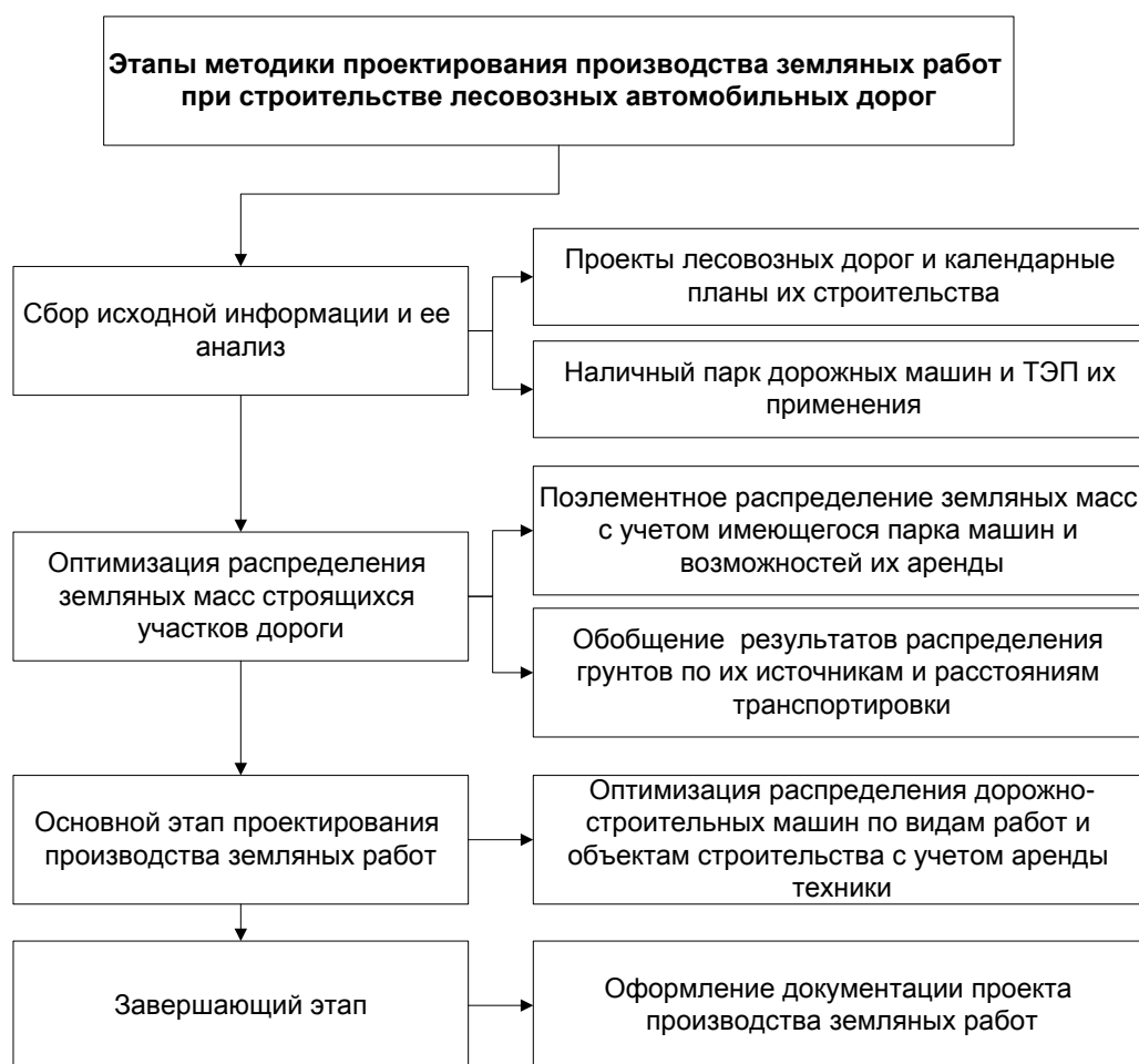
Рисунок 2- Общий алгоритм проектирования производства земляных работ
