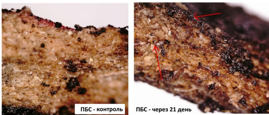
Рисунок 17 – РП-БС-9 до выдержки в активном грунте № 1 (а) и через 21 сутки (б).
