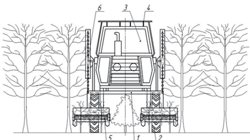
Рис. 4. Схема агрегата для коридорного осветления лесных культур
