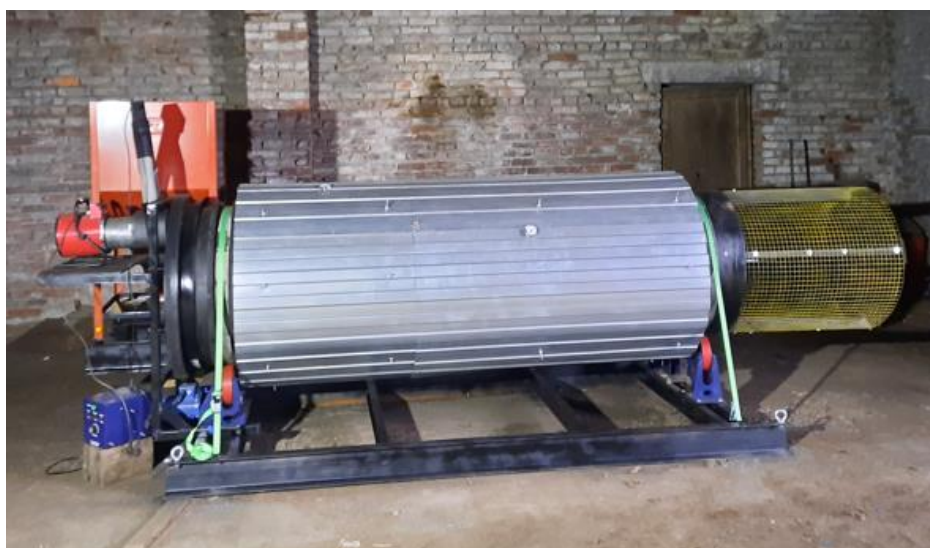
Рисунок 4.9. Опытно-промышленный биореактор барабанного типа в сборе (транспортное положение).
