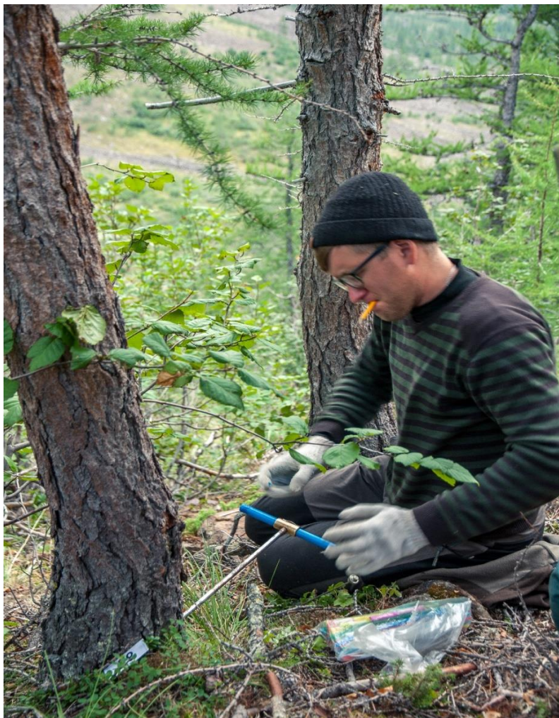
Рисунок 3.4. – Отбор образцов (кернов) древесины возрастным буровом
