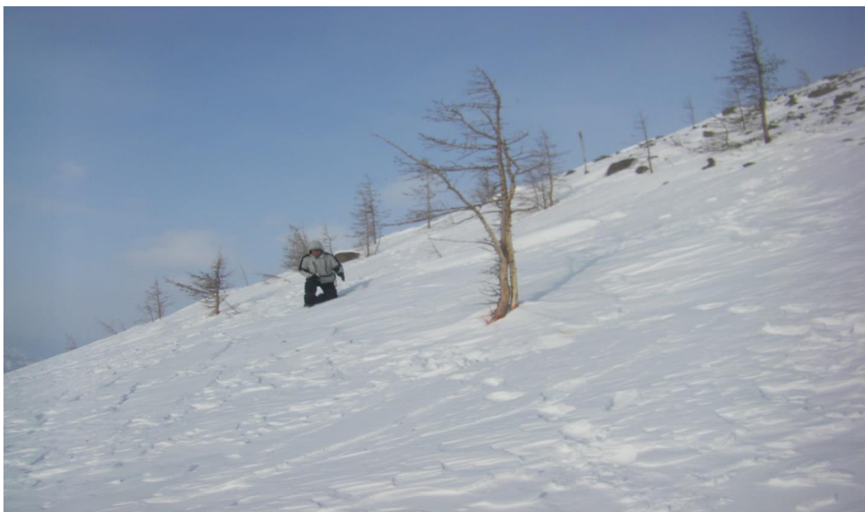
Рисунок 3.8 – Фиксирование высоты снежного покрова краской на стволе
