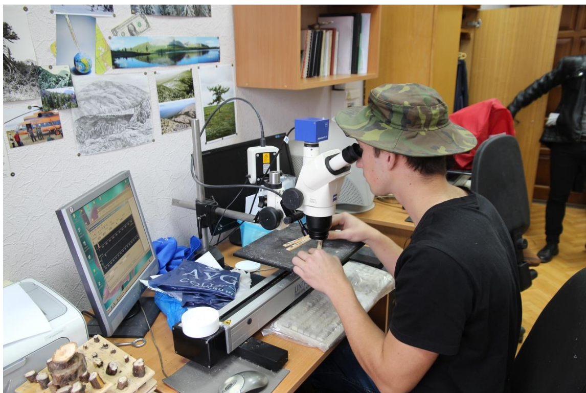
Рисунок 3.6 – Подсчёт годичных колец на полуавтоматической установке Lintab – 5
