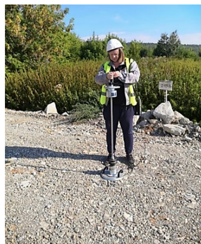
а) графическая зависимость изменения динамического прогиба дорожного покрытия (участок №5); б) измерение динамического модуля упругости щебеночного покрытия лесной дороги плотномером ZFG-3000-10 GPS
