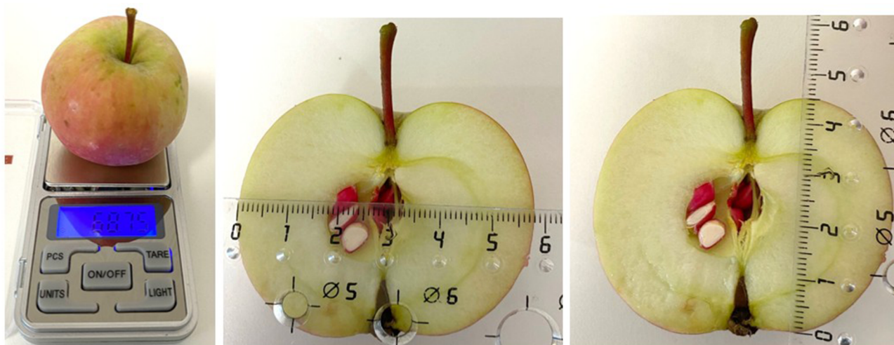
Рис. 1. Определение массы, диаметра и высоты плодов Fig. 1. Determination of weight, diameter and height of fruits
