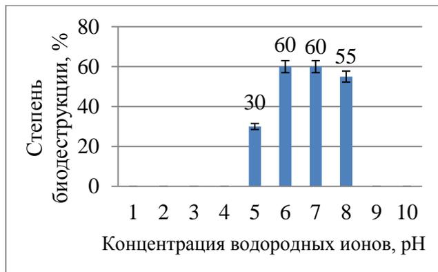
Рисунок 3 – Влияние концентрации водородных ионов на эффективность биодеструкции нитроцеллюлозы
