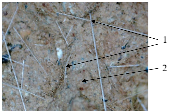
Рисунок 13 – Изображение структуры фиброцементогрунта в возрасте 28 суток твердения: 1 – стеклянные волокна; 2 – цементогрунтовая матрица
