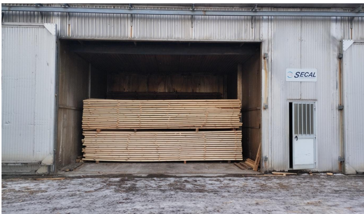
Рисунок 3.2 – Сушильная камера MGR-50
