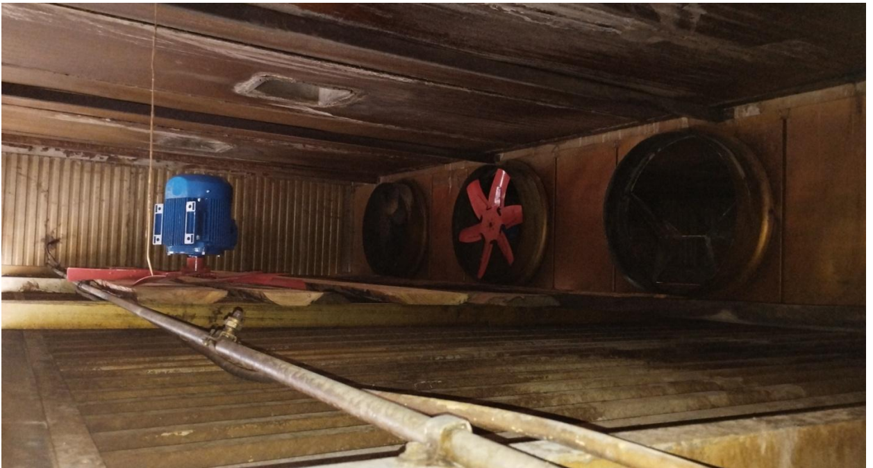
Рисунок 3.4 – Устройство верхнего циркуляционного канала камеры MGR-50
