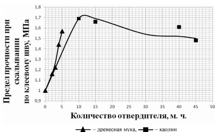
Рис. 1.8 Зависимость прочности склеивания от количества и вида используемого наполнителя
