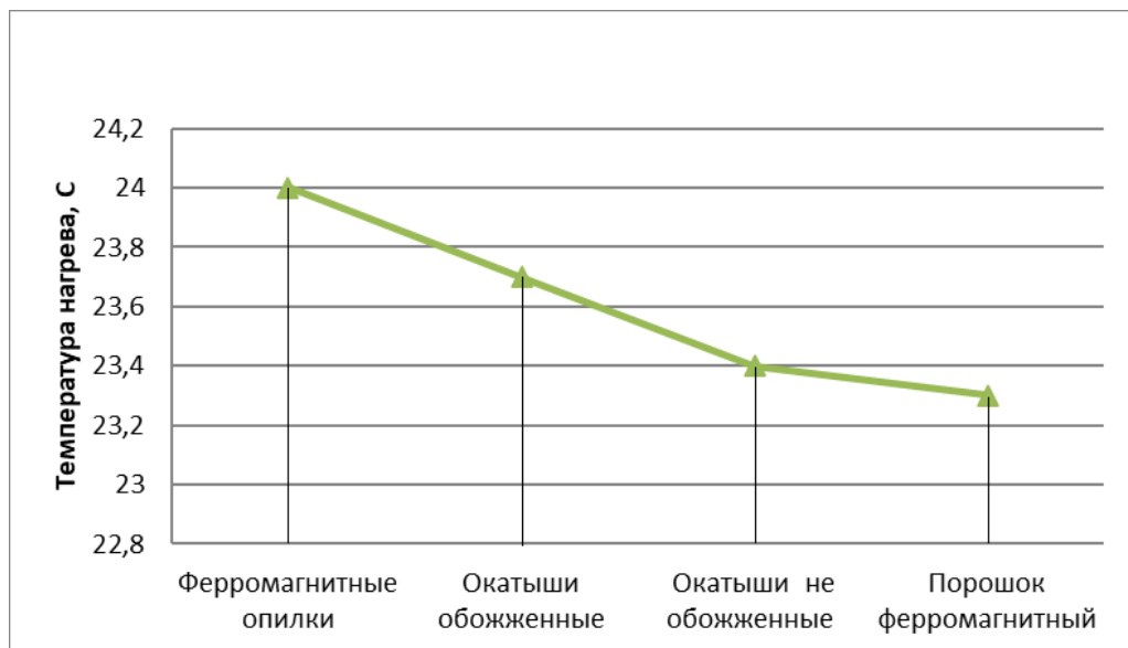
Рис. 4.6 Нагрев ферромагнитного наполнителя током с частотой 5,3 кГц
