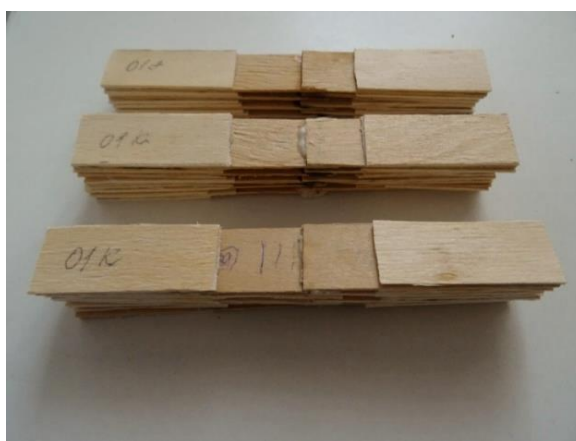
Рис. 3.14 Образцы шпона для испытаний на сдвиг
