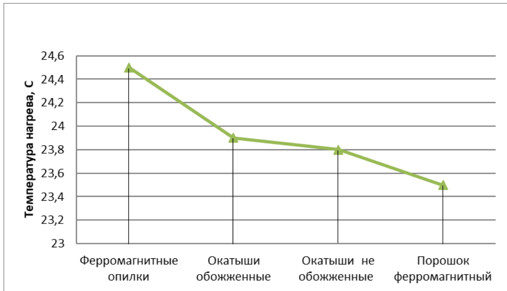
Рис. 4.7 Нагрев ферромагнитного наполнителя током с частотой 5,3 кГц
