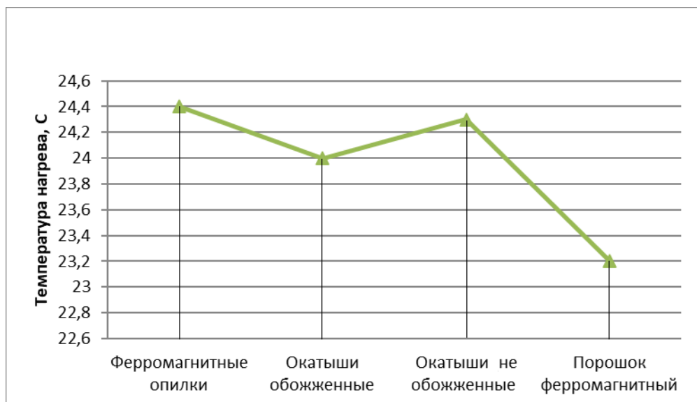
Рис. 4.11 Нагрев ферромагнитного наполнителя током с частотой 8,5 кГц
