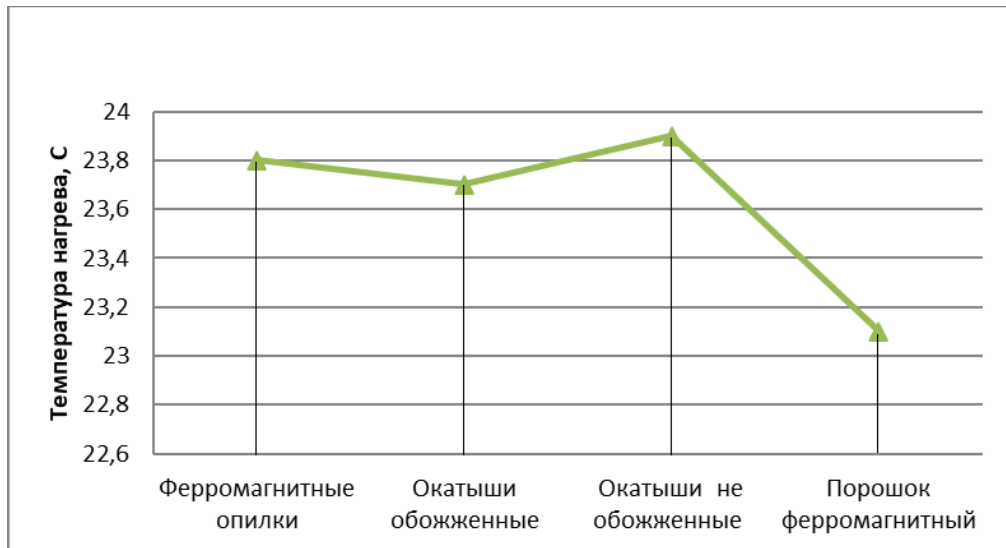
Рис. 4.10 Нагрев ферромагнитного наполнителя током с частотой 8,5 кГц
