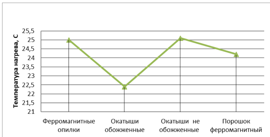
Рис. 4.8 Нагрев ферромагнитного наполнителя током с частотой 7 кГц
