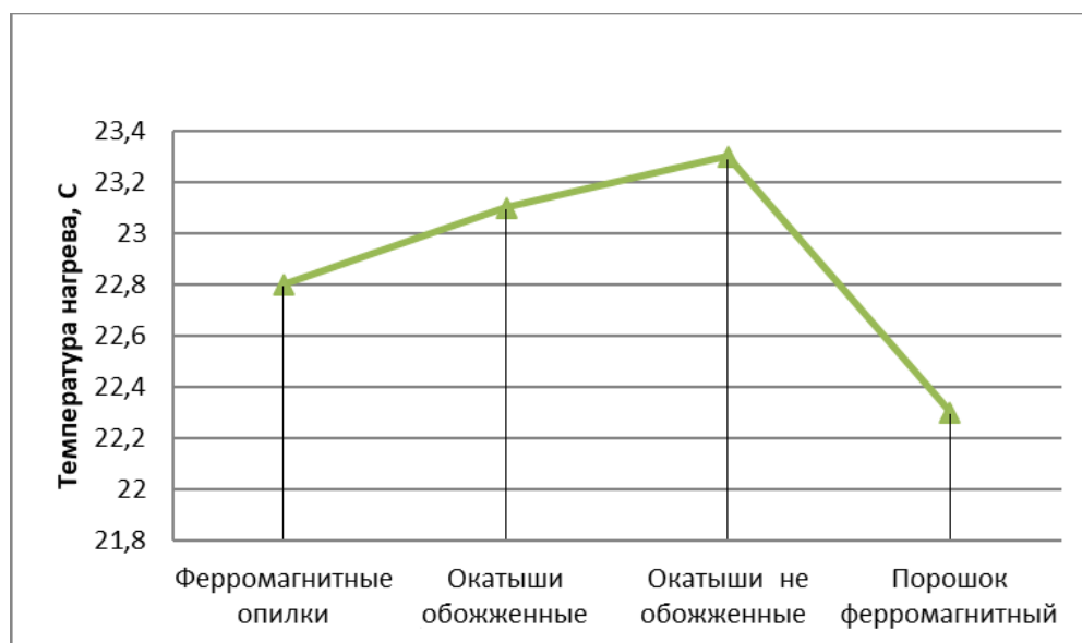
Рис. 4.14 Нагрев ферромагнитного наполнителя током с частотой 10 кГц
