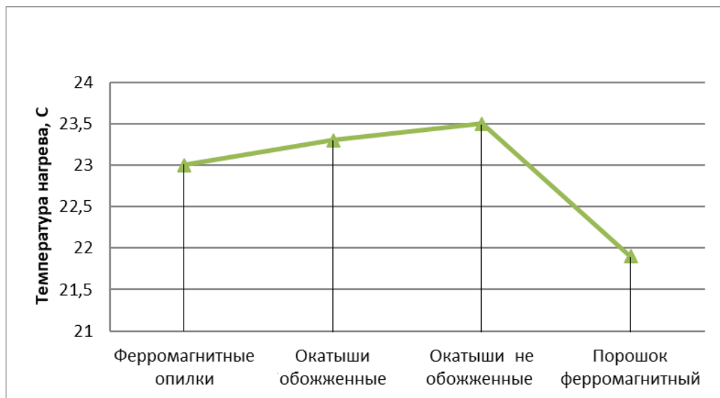
Рис. 4.12 Нагрев ферромагнитного наполнителя током с частотой 9,2 кГц
