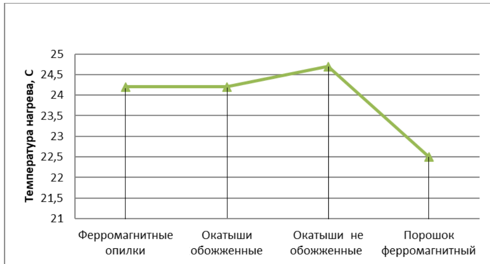
Рис. 4.13 Нагрев ферромагнитного наполнителя током с частотой 9,2 кГц
