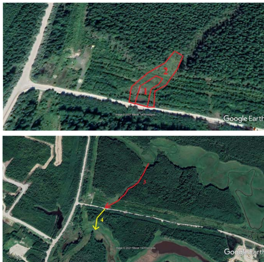
Рис. 5.1. Спутниковый снимок лесного участка с нарушенным гидрологическим режимом. Нефтеюганский район, Тепловское месторождение (данные с общедоступного интернет-ресурса Google Earth): 1 – зона затопления, 2 – зона подтопления, 3 – существующее направление стока по тальвегу ложбины, 4 – направление стока до строительства внутрипромысловой автодороги
