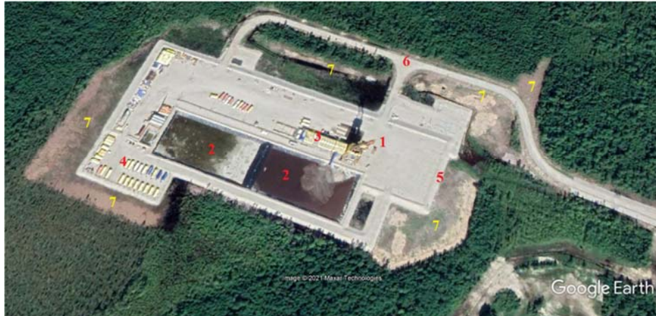
Рис. 5.3. Кустовая площадка на этапе строительства (эксплуатационного бурения) на спутниковом снимке 2021 г. (данные из общедоступного интернет-ресурса
