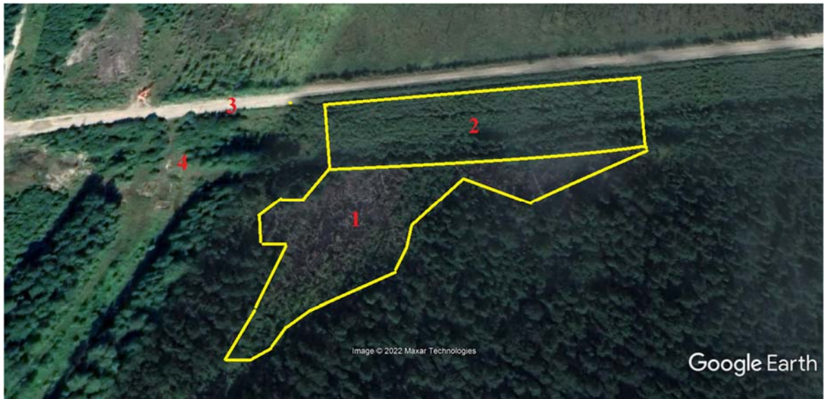
Рис. 5.22. Спутниковый снимок лесного участка, сильно загрязненного нефтесолевыми продуктами, через 23 года после аварии, Нефтеюганский район, Тепловское месторождение (данные с общедоступного интернет-ресурса Google Earth): 1 – загрязненный кедровник бруснично-зеленомошный, 2 – рекультивированный отсыпкой песком участок, зарастающий естественным хвойно-лиственным молодняком, 3 – внутрипромысловая автодорога, 4 – технический коридор нефтесборного коллектора, на котором произошла авария
