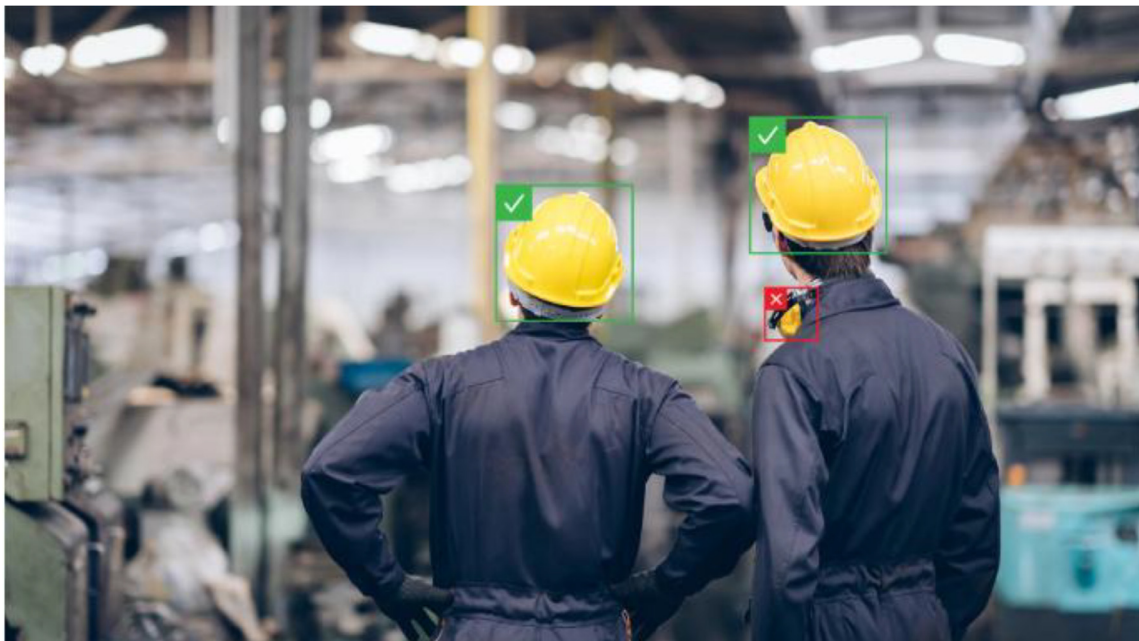
Рис. 7. Пример контроля применения средств индивидуальной защиты Fig. 7. Example of monitoring the use of personal protective equipment
